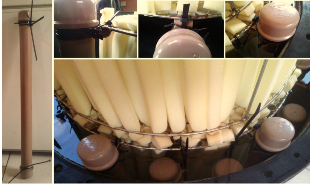
Figura 4.4 - Contrapesos feitos de tubos cilíndricos de PVC.
