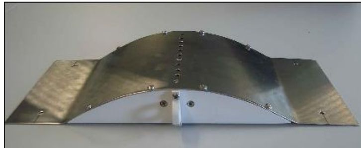
Figura 57 – Caixa de proteção para suporte do linígrafo.
