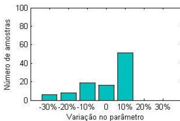
Figura 142 – Histograma do parâmetro NP, sistema La Terraza, Evento 2, com perturbação nos dados de precipitação de 15%.
