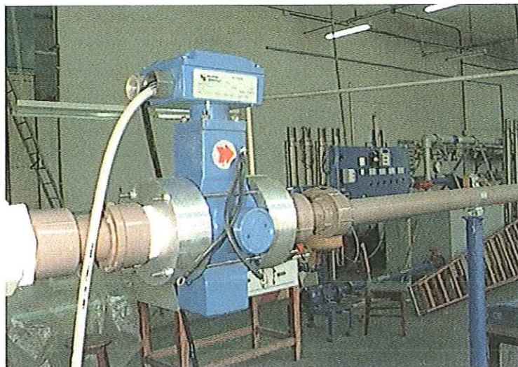
Figura 21 – Vista do transdutor de vazão de 32mm
