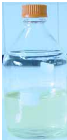
Figura 11. Reator desnitrificante com cultura purificada, amostra MMO3.
