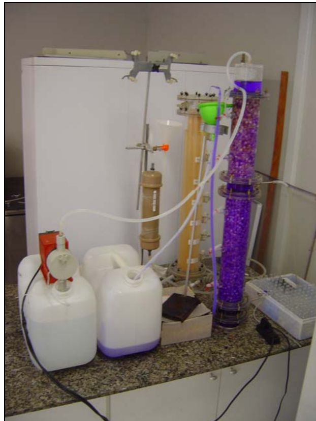
Figura 3: Fotografia do RAALF durante um dos ensaios hidrodinâmicos
