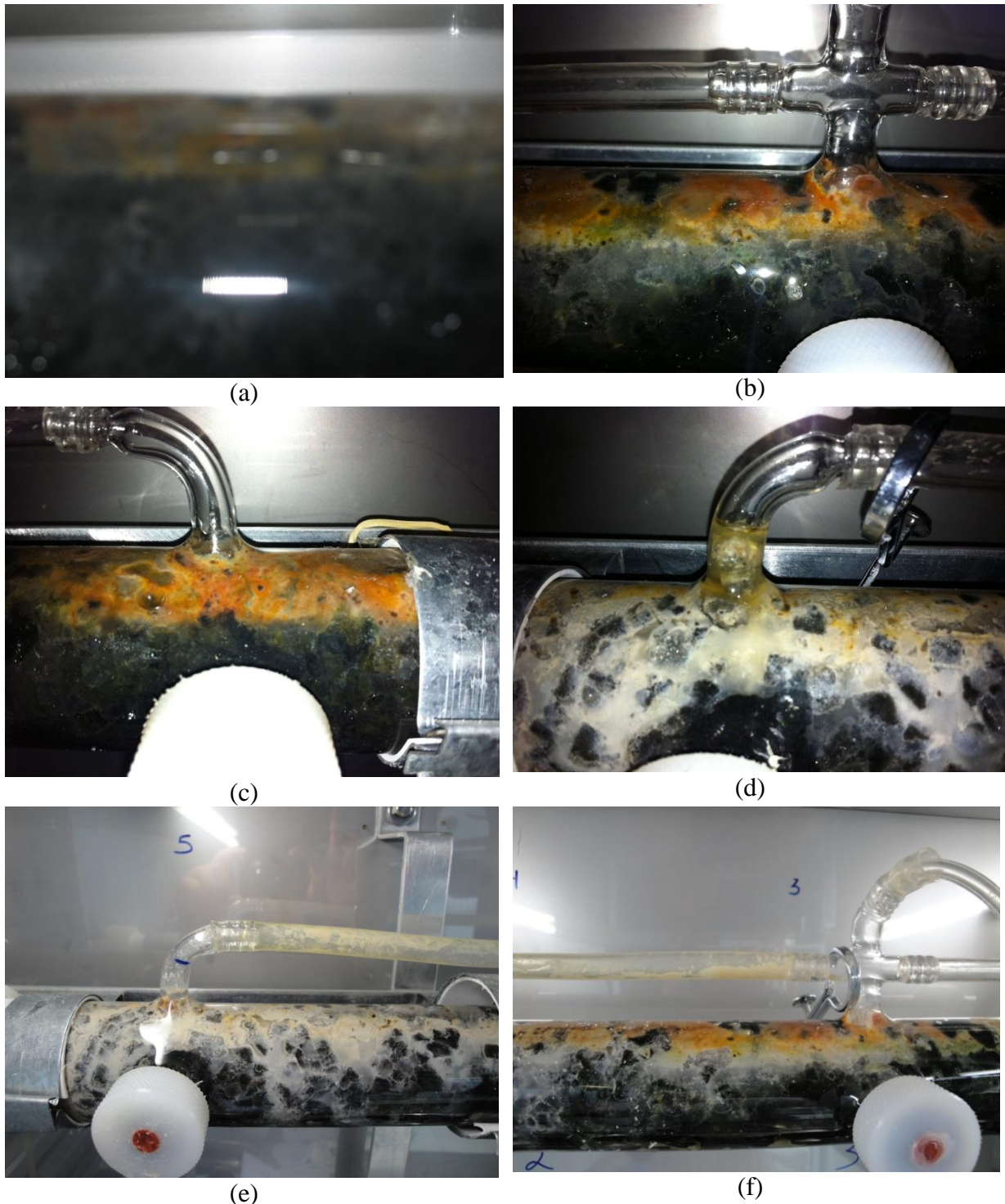
Figura 5.57 Formação de biofilme ao longo do RAHLF. (a) início da adesão do óleo a parede do reator; (b) e (c) biofilme amarelado formado na porção L/D 14 e L/D 19 do reator, respectivamente; (d) e (e) polímero de coloração esbranquiçada; (f) biofilme colorido na parte central (L/D 10) do reator.
