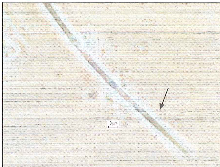
FIGURA 5.2.4 – Fotografia de microscopia óptica de contraste de fase da biomassa aderida ao suporte do BF no final da operação do reator, aumento 1.250x1.25 – Filamento semelhante ao tipo 021N (JENKINS et al., 1993)
