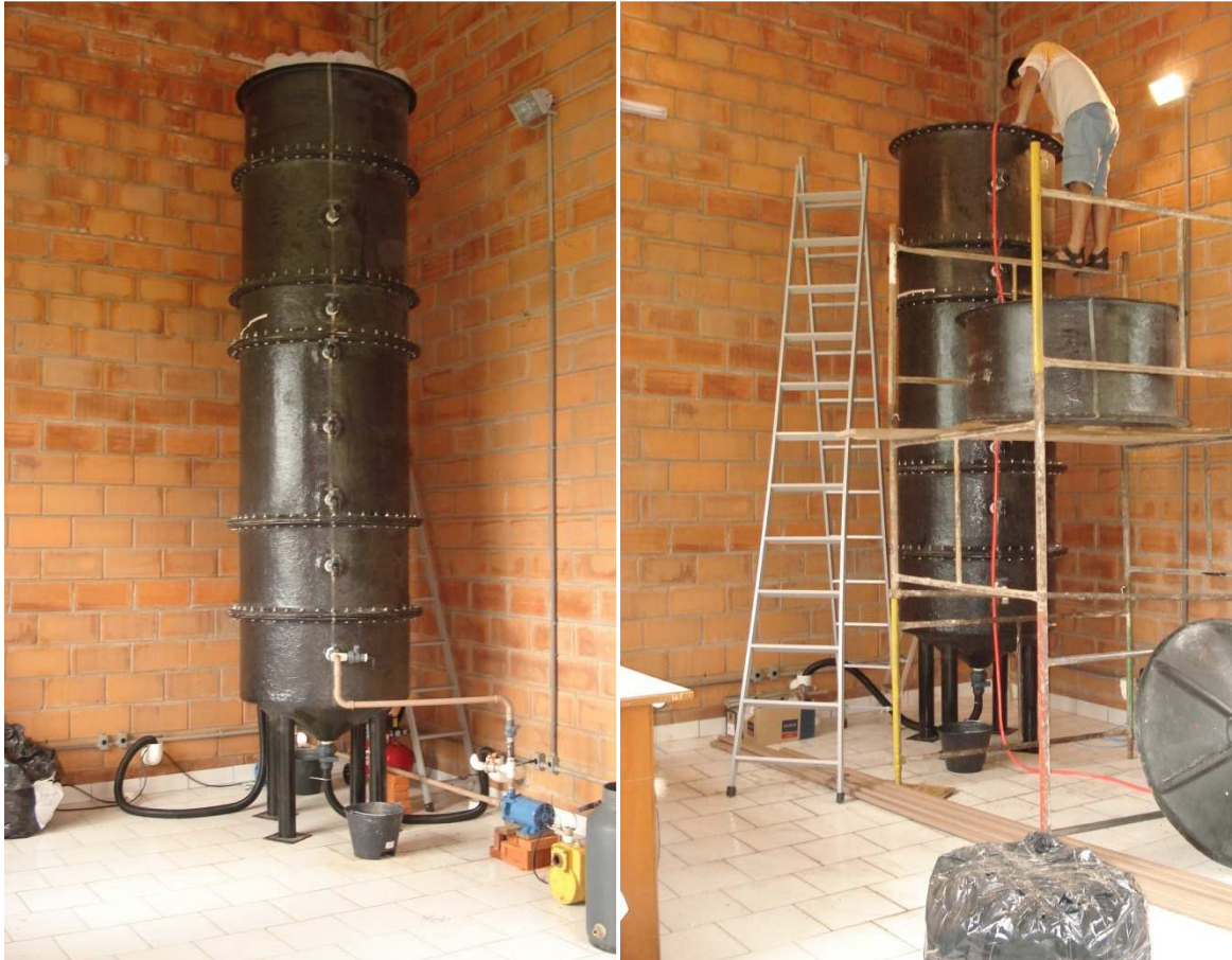
Figura 4.1 – Reator combinado anaeróbio-aeróbio em escala piloto
