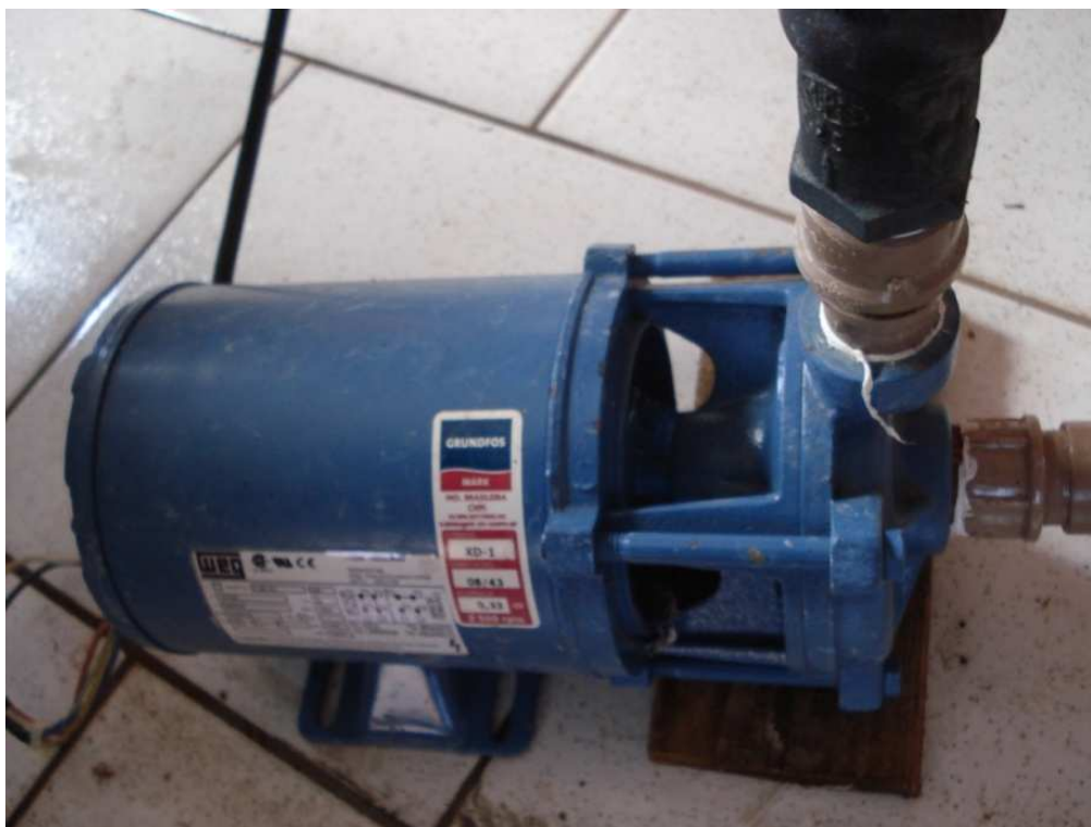
Figura 4.6 – Bombas de alimentação e recirculação utilizadas na pesquisa
