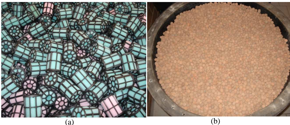
Figura 4.4 – Materiais suporte utilizados no experimento. (a) Espuma de Poliuretano (BioBob ® ); (b) Argila Expandida
