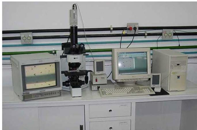
**Figura 4.4 – Sistema integrado para análise de imagens das partículas inertes.**
