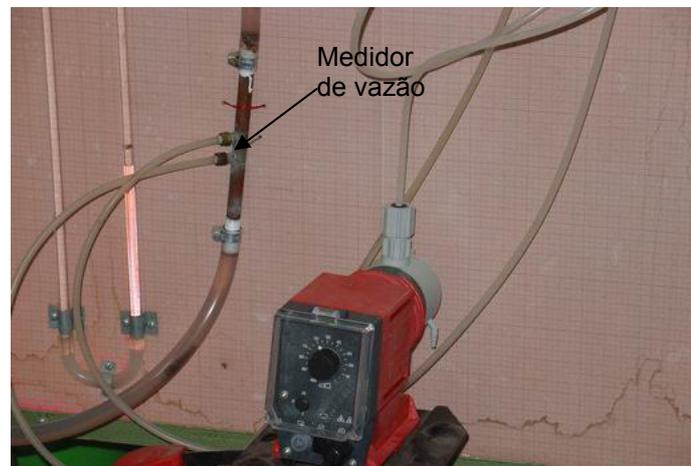
**Figura 4.9 – Medidor de vazão tipo orifício.**
