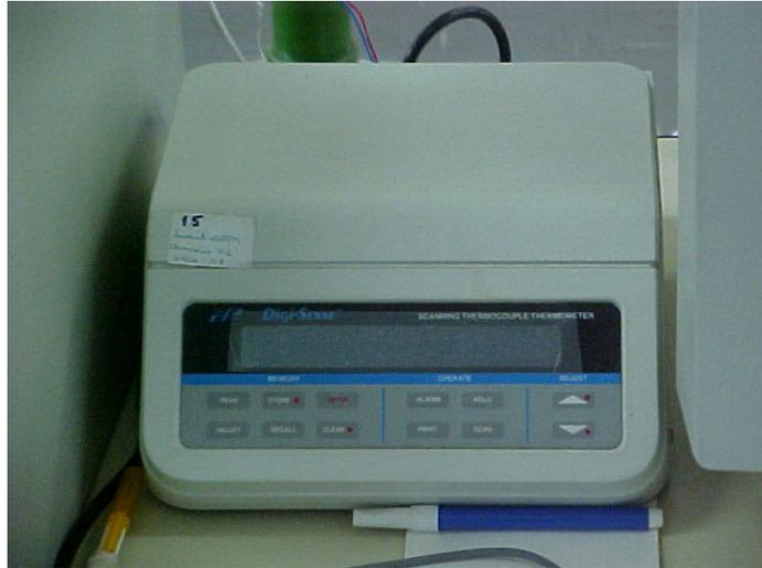
**Figura 4.16 – Central de registro de dados conectada ao microcomputador.**
