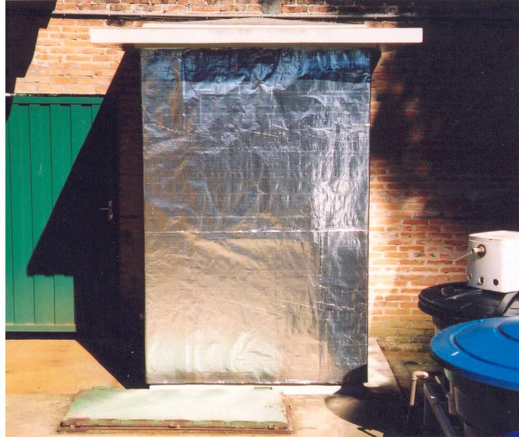
**Figura 4.13 – Cabine térmica com refrator / isolamento térmico.**
