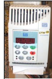
Figura 4.6b- Inversor de frequência para controle da rotação das paletas giratórias.
