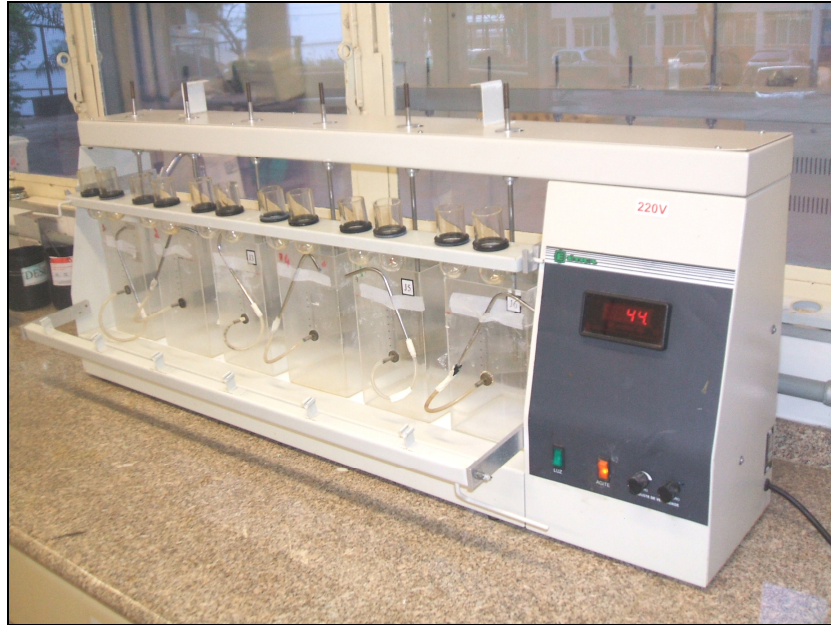
Figura 4.5 - Jar test com seis “jarros” (Ética) utilizado nos os ensaios de laboratório.
