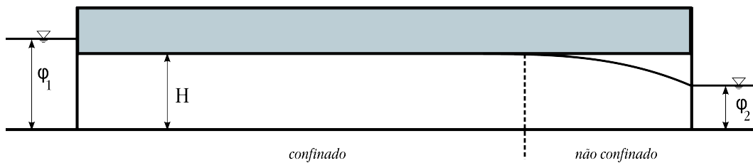
Figura 2.2 – Escoamento unidimensional com transição do regime confinado para o regime não confinado. Adaptado de (1).
