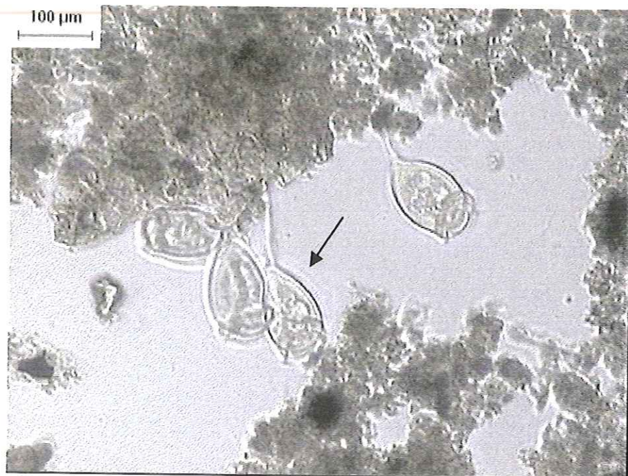
Figura 5.27- Microscopia óptica comum do lodo inoculado no BF: microrganismos ciliados fixos semelhantes a Epystilis sp.
