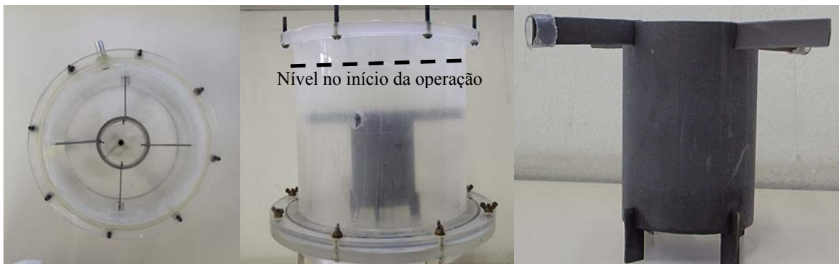
Figura 4.4 – Montagem do “draft-tube” para as operações em batelada.
