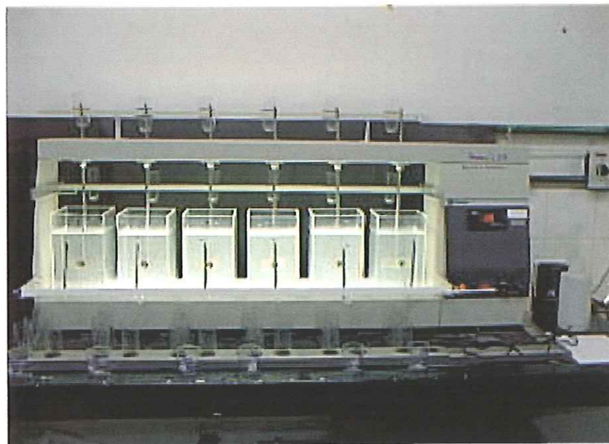
Figura 4.7 – Início da floculação ( G_f = 20 \text{ s}^{-1} )
