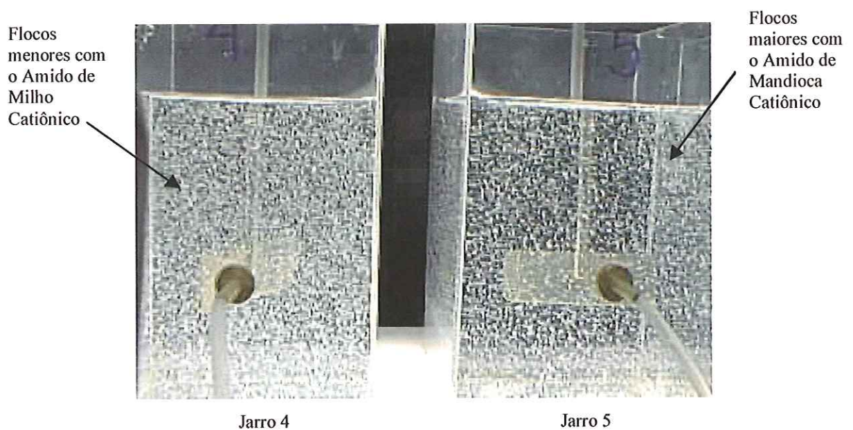
Figura 5.8 - Foto ilustrativa do ensaio com polímeros Oito minutos após a introdução dos polímeros no início da terceira câmara hipotética de floculação Ensaio variando o tempo de aplicação dos polímeros com o gradiente na floculação escalonado Jarros 4 e 5: 2,0 mg/L de Amido de Milho Catiônico e 1,0 mg/L de Amido de Mandioca Catiônico
