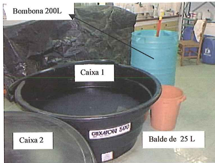
Figura 4.5 – Caixas d'água de 500 L para armazenamento e preparação da água de estudo e acessórios para homogeneizá-la antes de cada ensaio
