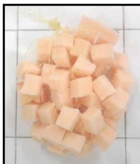
Figura 4.2 – Espuma de poliuretano usada como meio suporte para as bactérias nos filtros anaeróbio e aeróbio.
