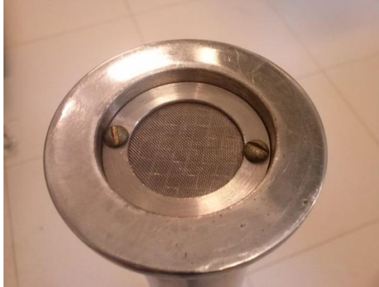
Figura 8 – Malha para retenção de partículas grossas.
