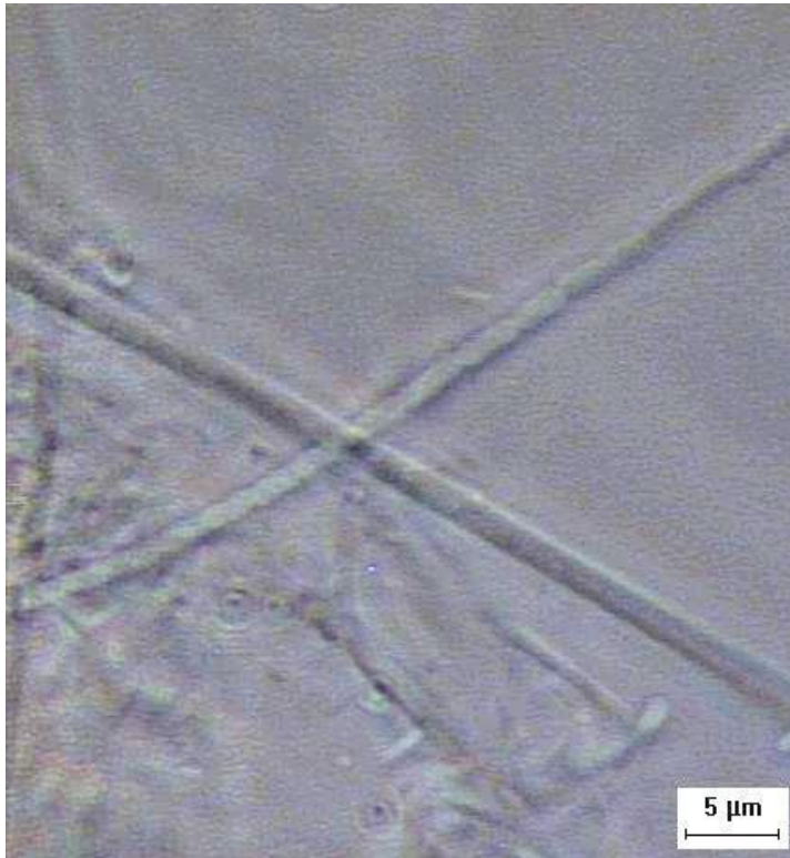
Figura 31 – Imagem da microscopia de material em suspensão retirado no 25º dia de operação do reator (Condição 1): emaranhado de bactérias filamentosas semelhantes ao gênero Sphaerotilus natans .
