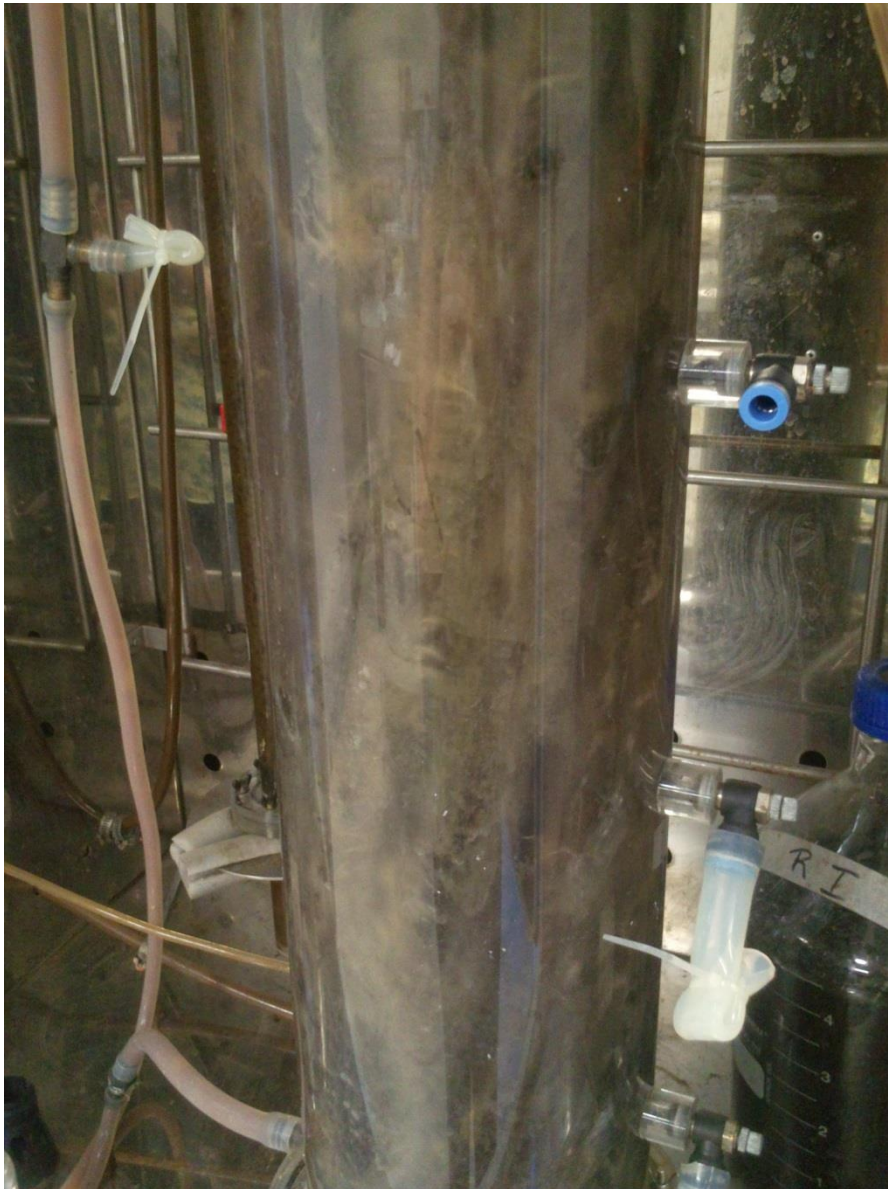
Figura 34– Fotografia do reator no final da Condição 4, destaque para o aspecto esbranquiçado do material em suspensão.
