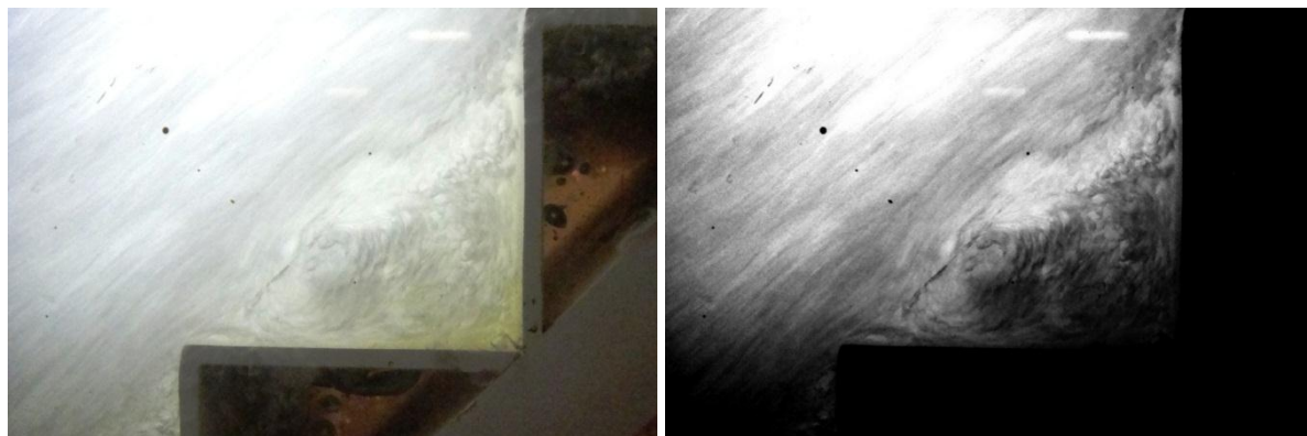
Figura A1.17 - Estas fotos são as mesmas. A primeira é a original, obtida na região de escoamento bifásico com T_e=1/400 s e sem flash (com ISSO 3200, maior do que os anteriores). A segunda é uma modificação obtida com um ajuste nos tons com o intuito de destacar o turbilhão formado na cavidade.
