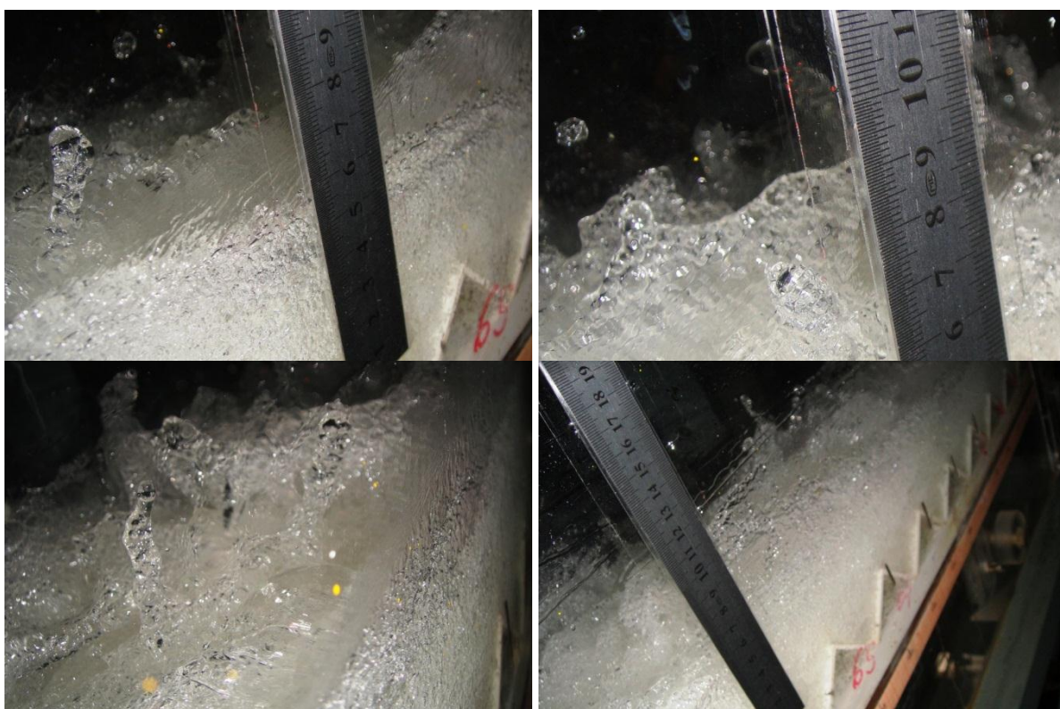
Figura A1.21 – Detalhes da superfície livre do escoamento bifásico.
