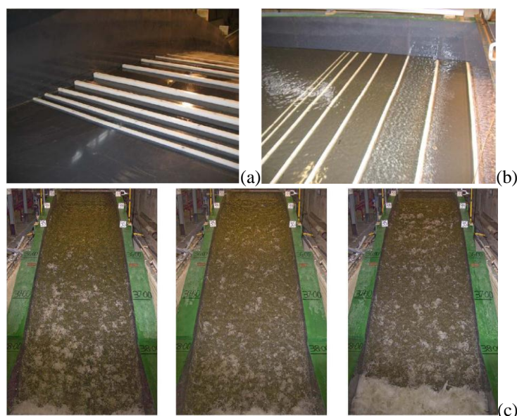
Figura 2.28 – Uso de macro-rugosidades a montante da crista padrão para aumentar a aeração superficial: (a) e (b) duas configurações testadas pelos pesquisadores e (c) Três imagens correspondentes a: 1 a - Sem as macro-rugosidades, 2 a e 3 a – Correspondem a duas configurações diferentes.
