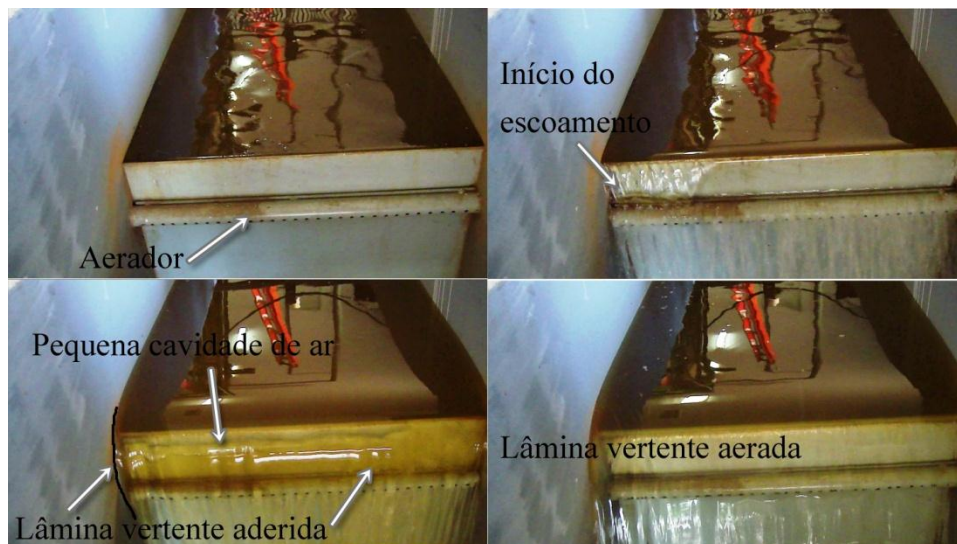
Figura 2.8 – Exemplo de uso de um conduto aerador em um vertedor de parede delgada. Vertedor situado no canal de restituição do Laboratório de Hidráulica Ambiental do Departamento de Engenharia Hidráulica e Saneamento – EESC – USP.
