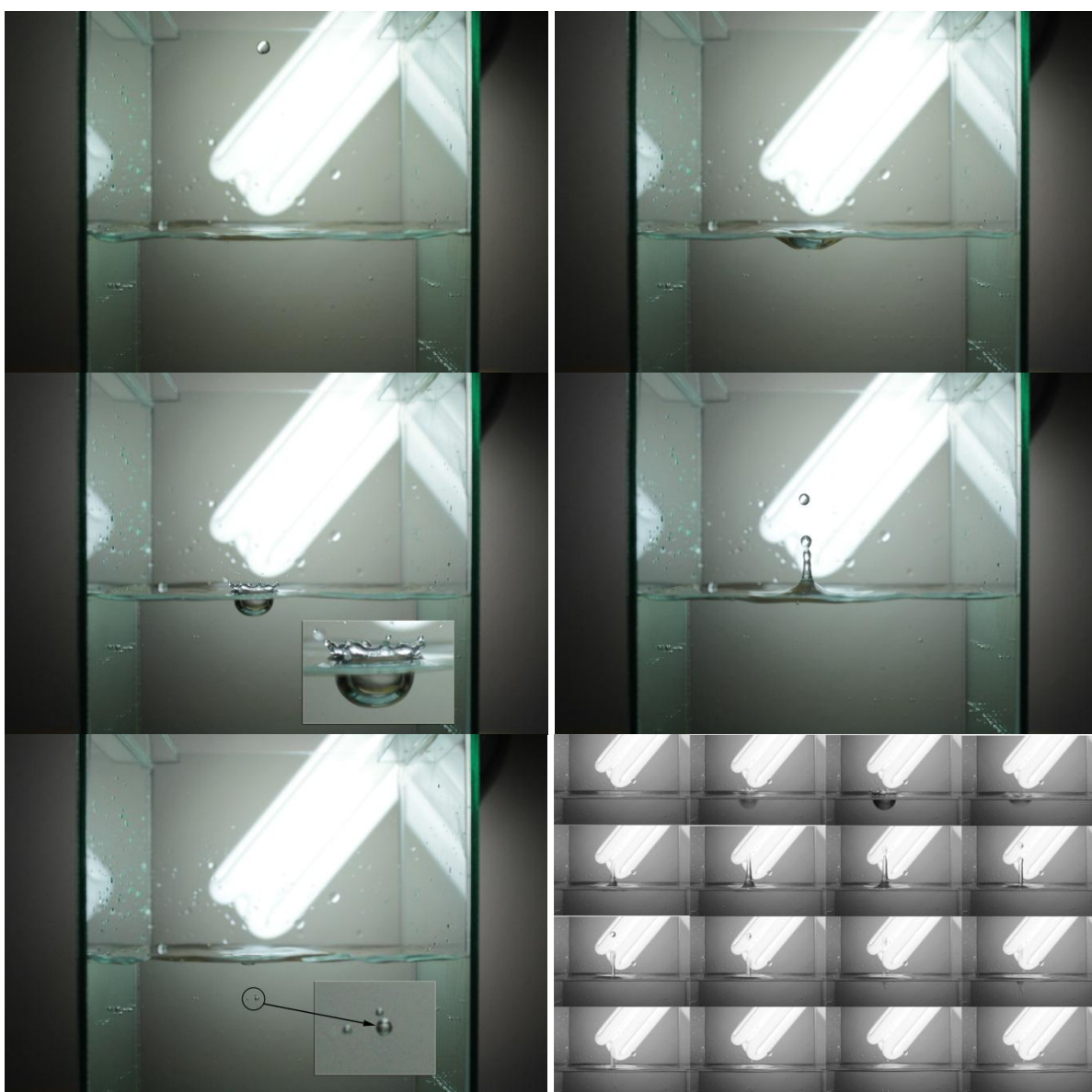
Figura A1.33 – As cinco primeiras fotos foram obtidas em experimentos individuais e ilustram a sequência de eventos de um experimento. A sexta imagem contém dezesseis fotografias sequenciais extraídas de um vídeo obtido com 60 fps (com uma máquina Canon T3i). Nota-se que a colisão da gota forma uma coroa que se fecha impulsionando o líquido para cima, havendo separação e a formação de uma nova gota. O retorno da coluna de líquido favorece a formação da bolha, que é impulsionada para baixo, sendo desacelerada pelos efeitos viscosos até parar e inverter o sentido do seu movimento, regressando à superfície.
