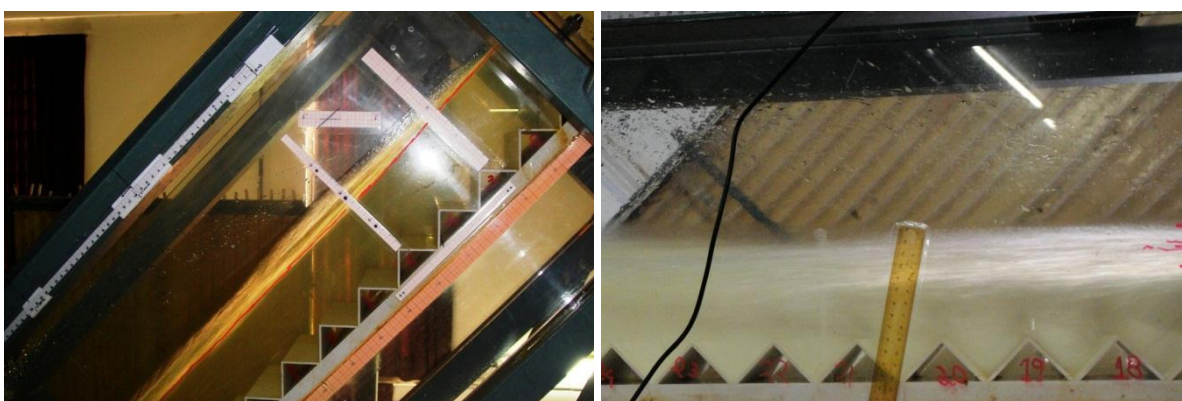
Figura A1.5 - Neste caso, na primeira imagem, foi traçada uma linha vermelha que, de forma aproximada, se sobrepõe à posição da superfície livre do escoamento monofásico. Observa-se que para estas condições de escoamento o trecho monofásico é translúcido. O mesmo não ocorre na imagem ao lado, que ilustra o aumento da opacidade ao longo do canal devido ao aumento da concentração de bolhas (a fotografia está inclinada, ou seja, o canal possui degraus com pisos horizontais). Dados: T_e=1/40 s com flash (esquerda) e T_e=1/13 s sem flash (direita).
