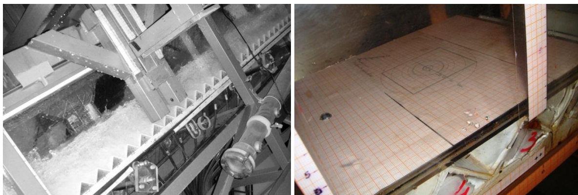
Figura A1.1 - Visão geral do canal em degraus (esquerda) e alvo utilizado para medir a distância desde o sensor até o pseudo fundo e para verificar a posição do emissor/receptor (direita).
