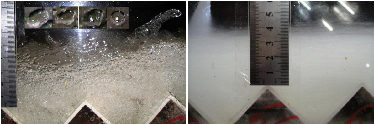
Figura A1.12 - A primeira foto foi obtida com flash e T_e=1/40 s. Ela permite observar uma forma alongada que emerge do escoamento principal e uma enorme quantidade de bolhas. Entre estas bolhas, há formas elipsoidais, bolhas disformes, como a segunda e a terceira em destaque, e bolhas esféricas, como a quarta. A Fotografia à direita mostra o aspecto esbranquiçado obtido com T_e= 1/10 s e sem flash. Neste caso, a profundidade de aproximadamente 4 cm não é a mesma profundidade média apresentada no Capítulo 3. Certamente o valor indicado na fotografia se aproxima de um valor máximo, mas sem considerar os máximos ocasionados por ejeções que ocorrem com certa frequência não capturada pela máquina fotográfica.
