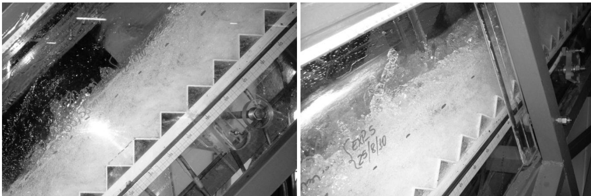
Figura A1.4 - Imagens do escoamento bifásico do Experimento 5. Nota-se na primeira fotografia a forma irregular da superfície livre, que é mais aparente na segunda fotografia (observa-se uma forma alongada que emerge do escoamento principal, voltada para montante).
