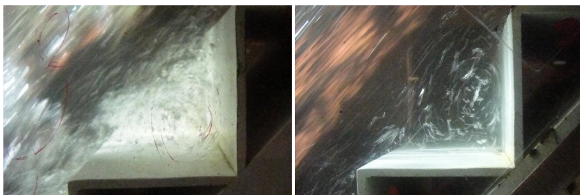
Figura A1.18 - Ao ocorrer uma injeção de ar, ela pode penetrar até abaixo do pseudo-fundo, como ilustrado na fotografia à esquerda, que corresponde à região de transição, ou seja, com injeções intermitentes de ar. À direita é possível observar o turbilhão na região de escoamento monofásico por meio dos traços deixados pelo movimento de pequenas bolhas introduzidas no escoamento ( T_e=1/500 s, sem flash).
