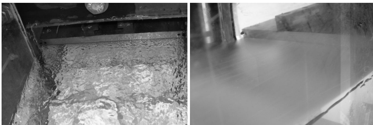
Figura A1.3 - Superfície livre do escoamento monofásico a jusante da comporta. Estas imagens destacam a estrutura real da superfície livre (imagem à esquerda) e a superfície livre lisa e bem definida obtida em uma fotografia com tempo de exposição um pouco maior e sem o uso de flash (à direita). A segunda fotografia se aproxima mais da imagem percebida pela visão humana para escoamentos com velocidades semelhantes às velocidades correspondentes a estas fotos. Tempo de exposição, T_e , 1/40 s (esquerda/com flash) e 1/2 s (direita/sem flash).
