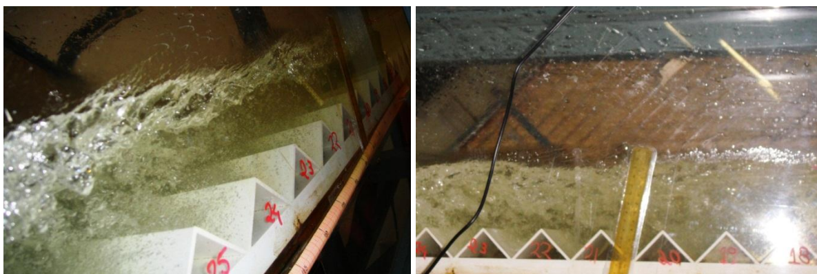
Figura A1.6 - A primeira fotografia foi obtida com T_e=1/40 s e com flash. Esta imagem ilustra o mesmo que a segunda imagem anterior, isto é, a evolução da concentração de bolhas ao longo do escoamento. Entretanto, não é observada a sobreposição das bolhas e sim as próprias bolhas, inclusive no interior das cavidades formadas pelos degraus. A segunda imagem é mais um exemplo que mostra irregularidades na superfície livre.
