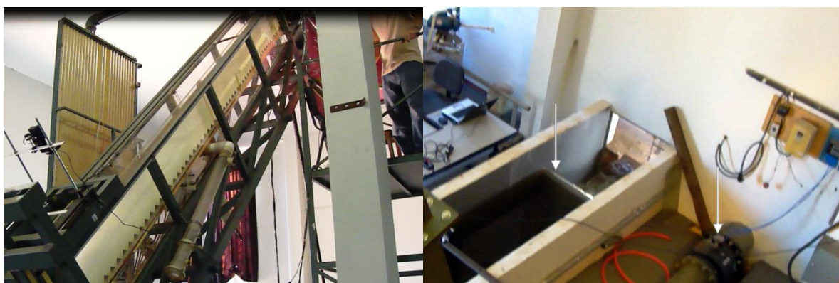
Figura A1.28 – Foto do canal em funcionamento, sensor sobre o veículo e a plataforma utilizada para acessar a extremidade inicial do canal (esquerda); vista do vertedor de parede delgada e do medidor eletromagnético.
