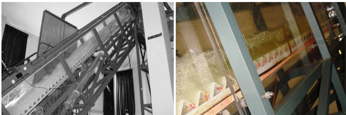
Figura A1.20 – A primeira imagem fornece uma visão geral do escoamento. A segunda foto evidencia, por meio de uma imagem instantânea (obtida com flash e T_e=1/40 s), a distribuição espacial das bolhas, com um aumento da concentração ao longo do canal.
