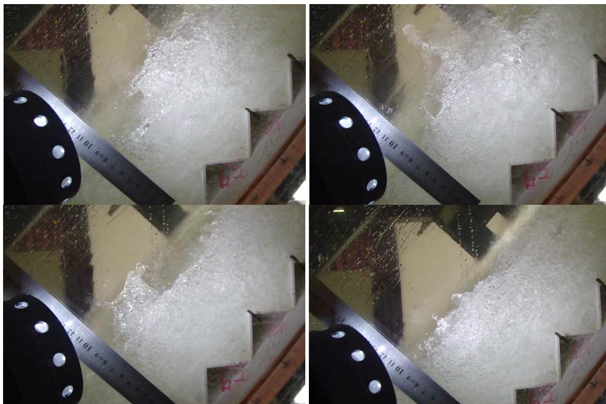
Figura A1.22 – Estes são exemplos de imagens extraídas de um filme obtido com a mesma máquina citada anteriormente, 29 frames/s e o auxílio de um estroboscópio. É interessante notar a formação de diferentes estruturas na posição iluminada.
