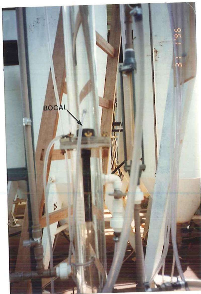
Figura 4.4 - Fotografia do bocal fixado à 0,50 m do fundo da coluna de ensaios
