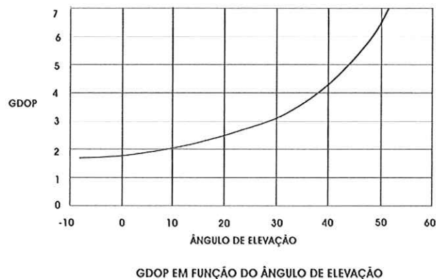
Figura 5.5: GDOP em função do ângulo de elevação em graus Fonte: Parkinson & Spilker Jr. (1996).
