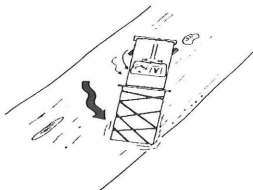
FIGURA 2.12. Defeito pista escorregadia (SANTOS et al., 1988).
