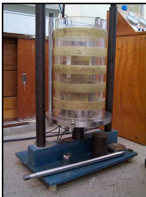
FIGURA 3.11 – Montagem da câmara triaxial – COPPE/UFRJ
