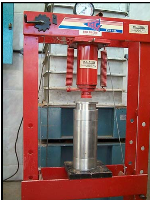
FIGURA 3.12 – Prensa utilizada para compactação dos corpos de prova na COPPE/UFRJ
