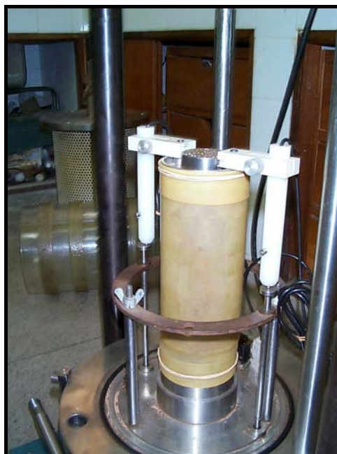
FIGURA 3.10 – LVDTs fixados no corpo-de-prova já instalado na base da câmara triaxial – COPPE/UFRJ
