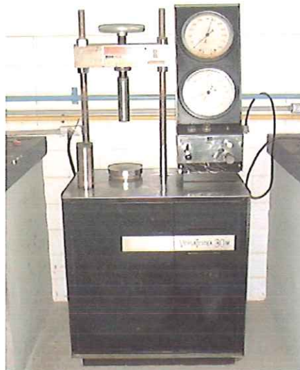
FIGURA 3.4 – Prensa utilizada para compactação dos corpos de prova
