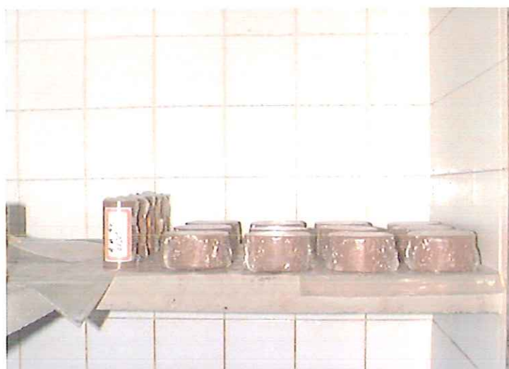
FIGURA 3.6 – Cura dos corpos de prova na câmara úmida
