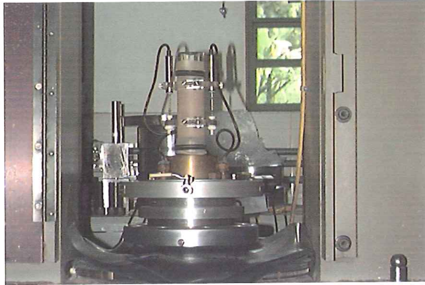
FIGURA 3.8 – Corpo de prova instalado na base da câmara triaxial
