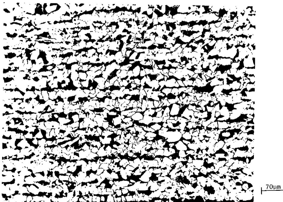
FIGURA 19: Microestrutura da chapa base. Aumento de 125x.
