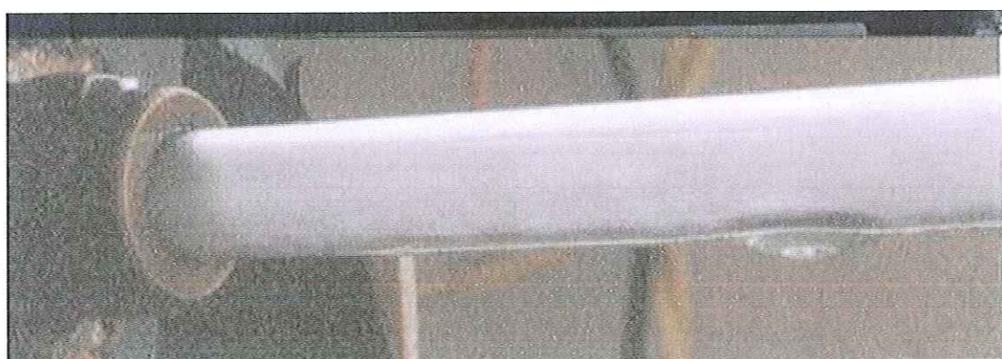
Figura 4.21 Padrão de escoamento em Névoa , obtida para as condições: R134a, T_{\text{Evap}}=5^{\circ}\text{C} , \phi=5 \text{ kW/m}^2 , G=500 \text{ kg/s.m}^2 e D=9,52\text{mm} .
