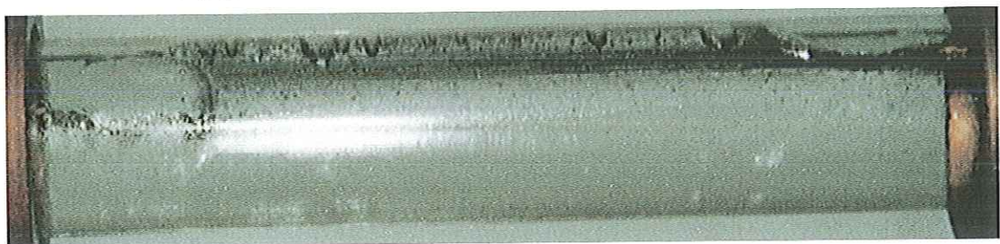
Figura AII.15 Transição do padrão em Bolhas para o Pistonado . R134a e D_i=12,7\text{mm} .
