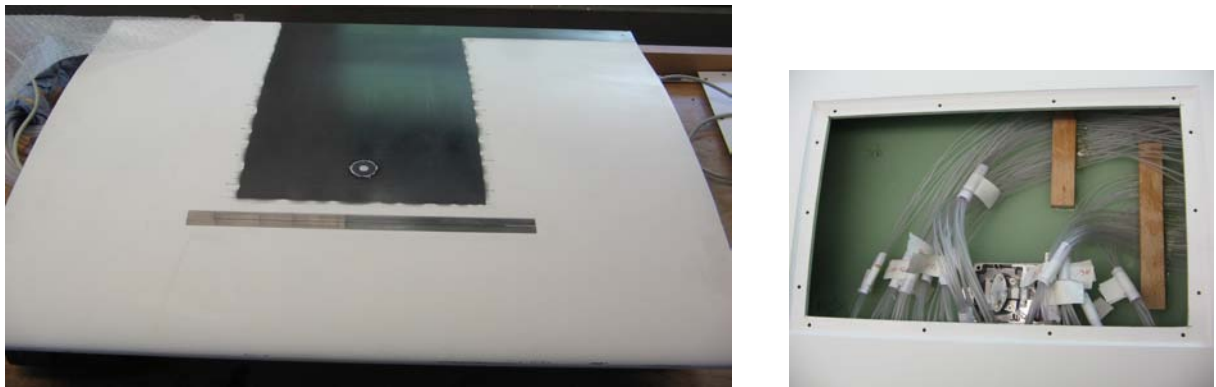
Figura 3.17: Modelo construído e janela para ajuste e manutenção localizada na superfície inferior do modelo.
