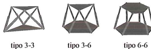
Figura 3.2 – Configurações da Plataforma de Stewart (BEN-HORIN et al., 1998).
