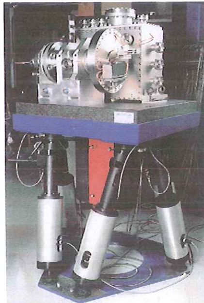
Figura 2.6 – Equipamento de posicionamento da European Synchrotron Radiation Facility ( http://www-sop.inria.fr/coprin/equipe/merlet/Photo/section3_4.html ).
