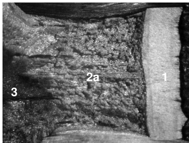
Figura 72: Superfície de fratura de espécime SE(T) com trinca profunda, com entalhe lateral, após ensaio de integral J, por técnica de de normalização linear, CTP05-EL-NQ
