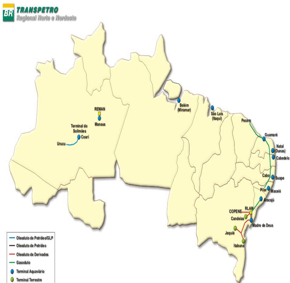
Figura 4: Sistema Dutoviário do Norte-Nordeste do Brasil, Transpetro (2005).
