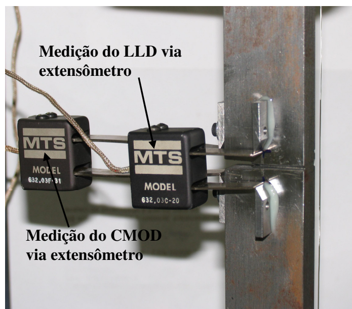
Figura 43: Dois extensômetros acoplados no espécime SE(T) com entalhe lateral. O primeiro na extremidade da largura e o segundo na linha de carregamento, durante o ensaio de Integral J para o aço API 5L X60
