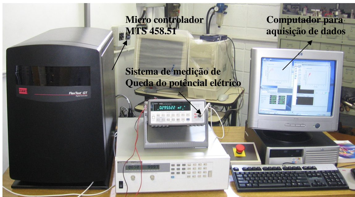
Figura 25: Sistema de operação analógico digital MTS Flex Test GT. Fonte e aquisição de queda de potencial elétrico. E computador de controle e aquisição de dados
