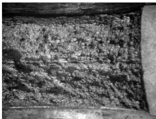
Figura 80: Superfície de fratura de espécime SE(T) com trinca rasa, com entalhe lateral, CTR06-EL-NV
