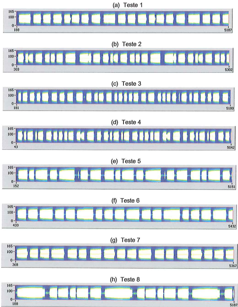
FIGURA 5.4 – Imagem direta dos regimes de escoamento dos testes apresentados na TABELA 5.1 (branco corresponde ao ar e azul escuro a água).
