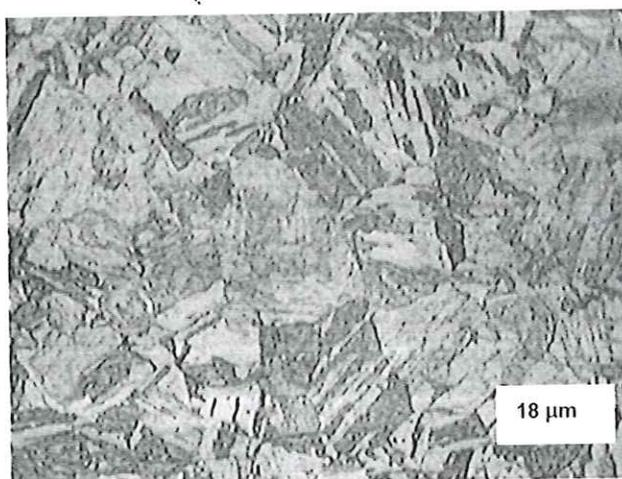
Figura 23- Amostra metalográfica retirada na orientação LT, com aumento de 500x.
