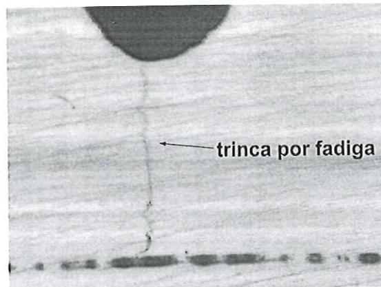
Figura 15 - Detalhes do corpo de prova com pré-trincamento na razão  $a/W = 0.2$
