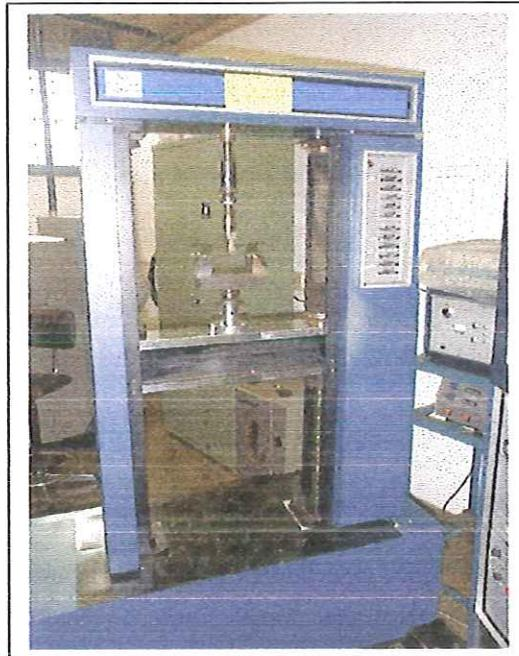
Figura 39. Máquina de ensaio Universal
