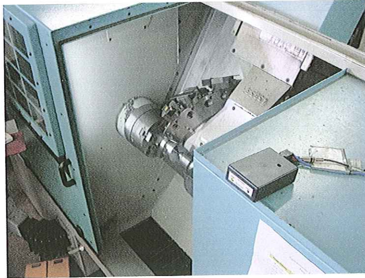
FIGURA 3.1.2 – Interface receptora posicionada fora do “ambiente de usinagem”, facilitando a instalação
