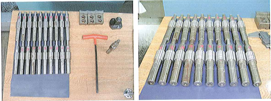
FIGURA 4.2.6 – Usinagem seriada de 20 peças: Antes e depois da usinagem do colo
