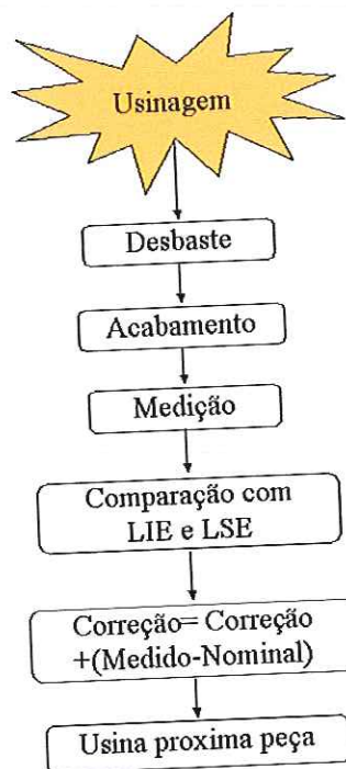
FIGURA 4.2.5 - Usinagem com controle dimensional através de medição com apalpador e correção do comprimento da ferramenta de corte
