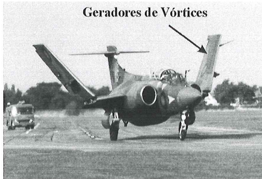
Figura 09. O Buccanner que dobra suas asas, com os geradores de vórtice fixados perto do bordo de ataque principal de sua asa esquerda. BUCCANNER (2003).
