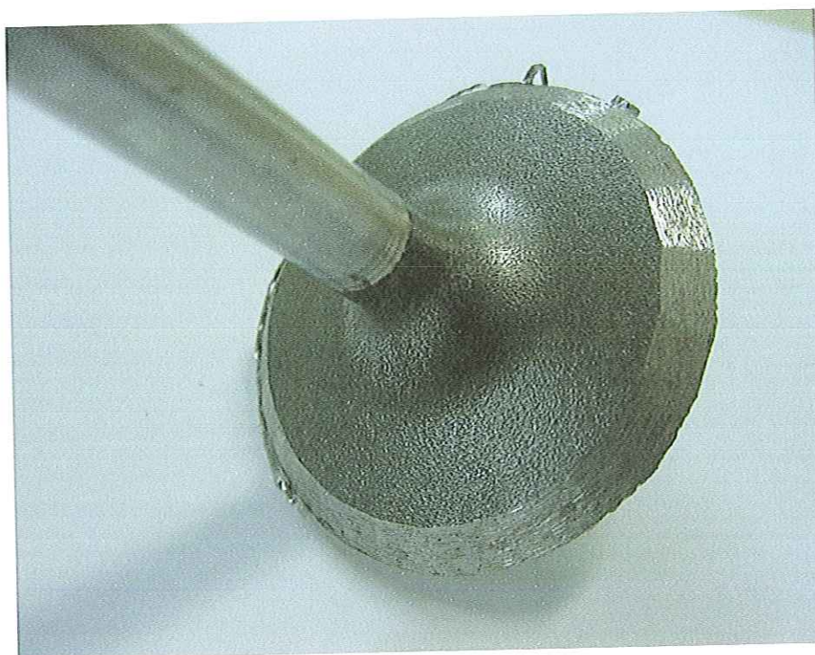
Figura 43 – Foto da peça que vibrou durante a retificação com v_f de 16mm/min.
