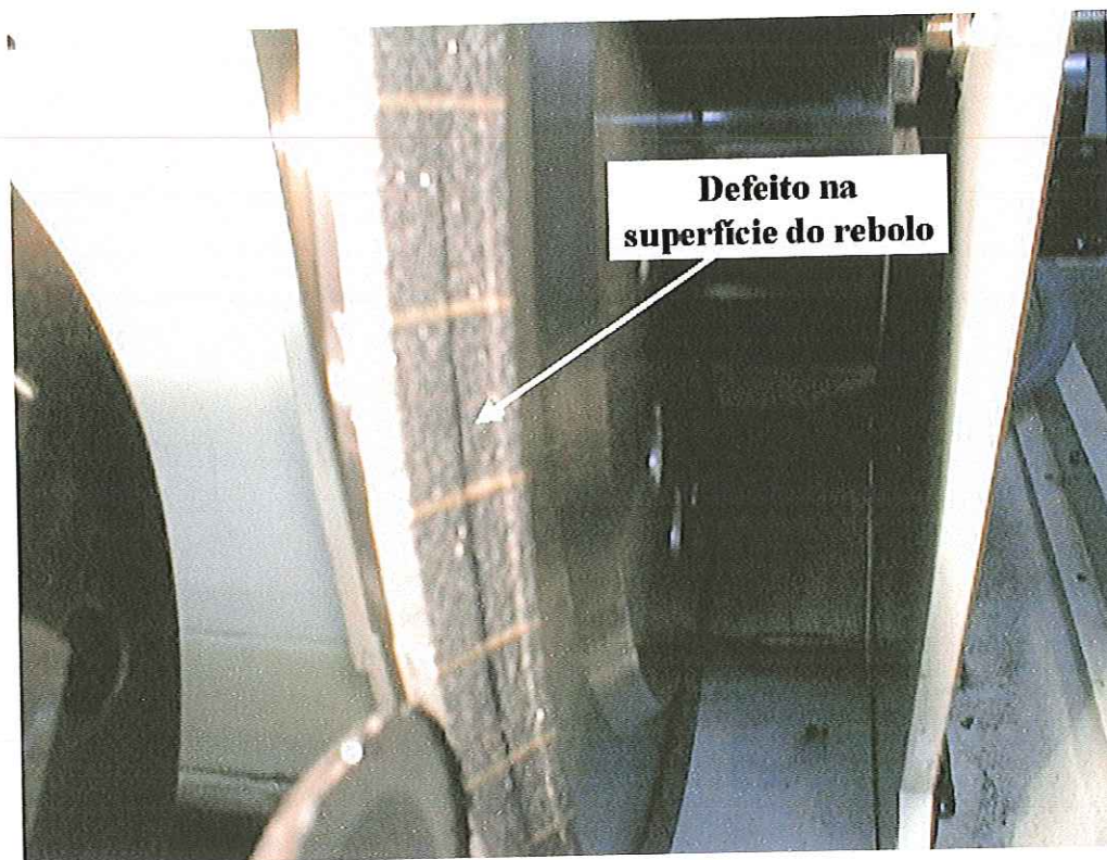
Figura 38 – Situação do rebolo após acidente de retificação com v_f de 16mm/min.
