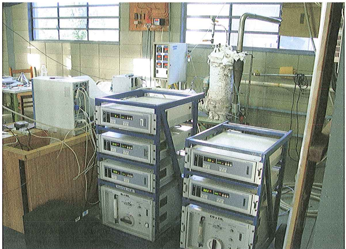
FIGURA (3.11) – Analisadores de gases Horiba para SO 2 , CO 2 , CO e O 2 .
