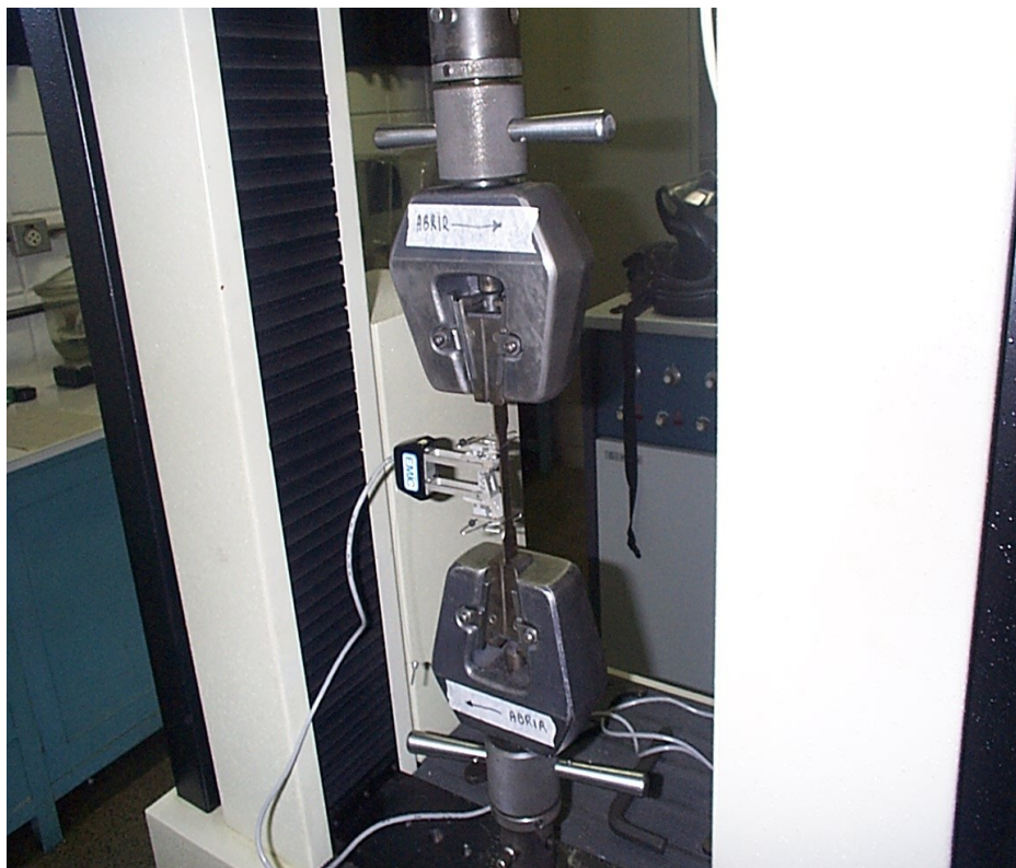
Figura 6.5 CDP acoplado à máquina de ensaios
