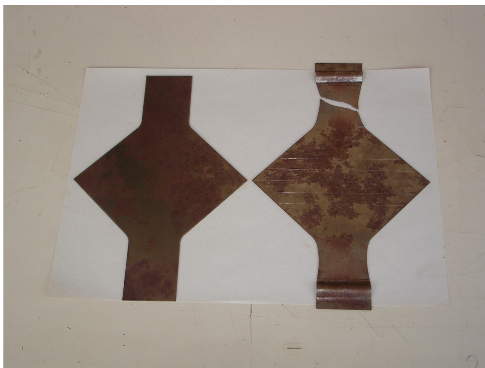
Figura 7.9 CDP estirado até a ruptura sem ocorrer a flambagem (direita) e CDP não deformado (esquerda)
