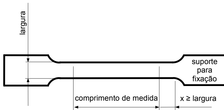
Figura 3.1 Corpo de prova genérico para ensaio de tração
