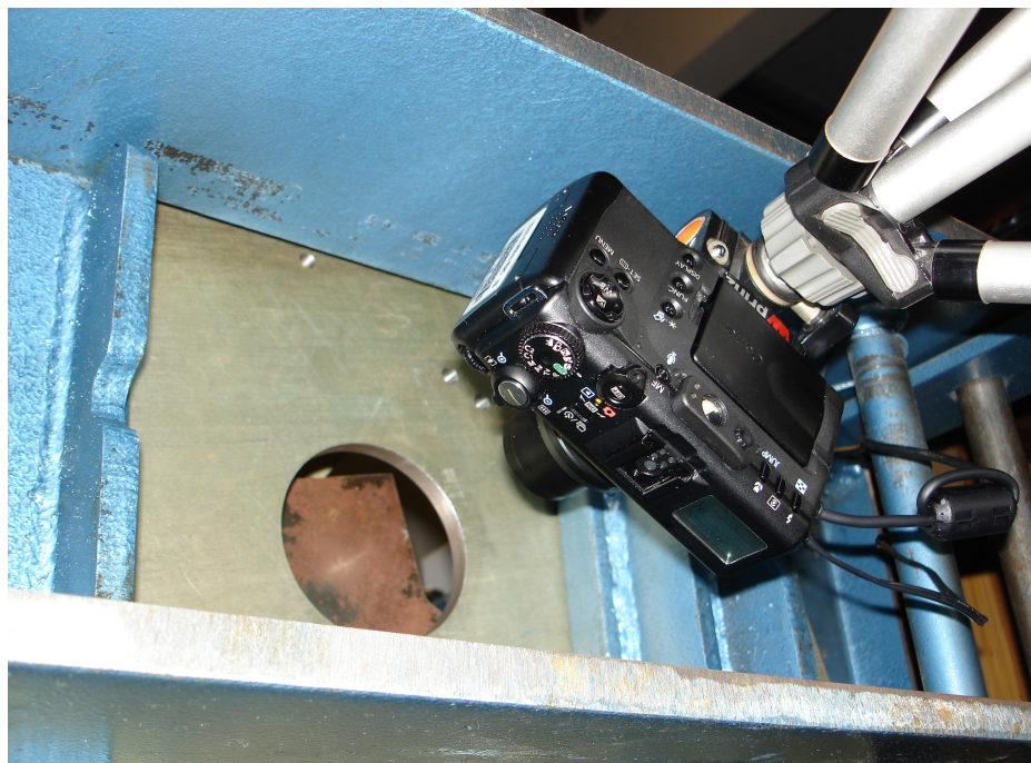
Figura 7.7 Detalhe da câmera posicionada abaixo do barramento da prensa fotografando uma face do CDP
