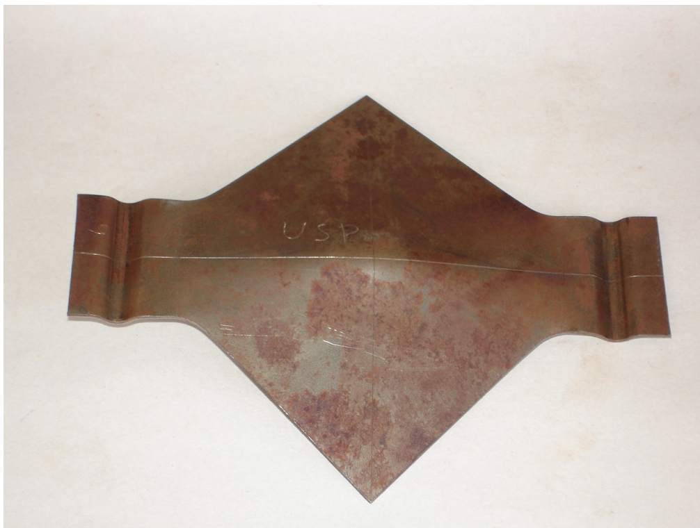
Figura 7.10 Ensaio com o CDP encurtado na região dos braços
