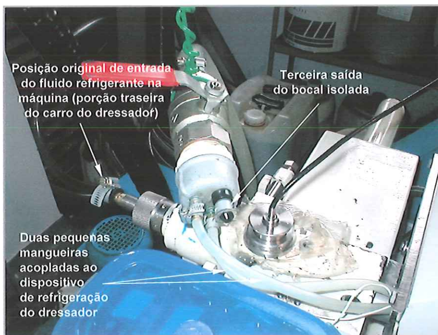
Figura 52: Registro para o controle de vazão do fluido refrigerante e mangueiras de alimentação do dispositivo de refrigeração do dressador.
