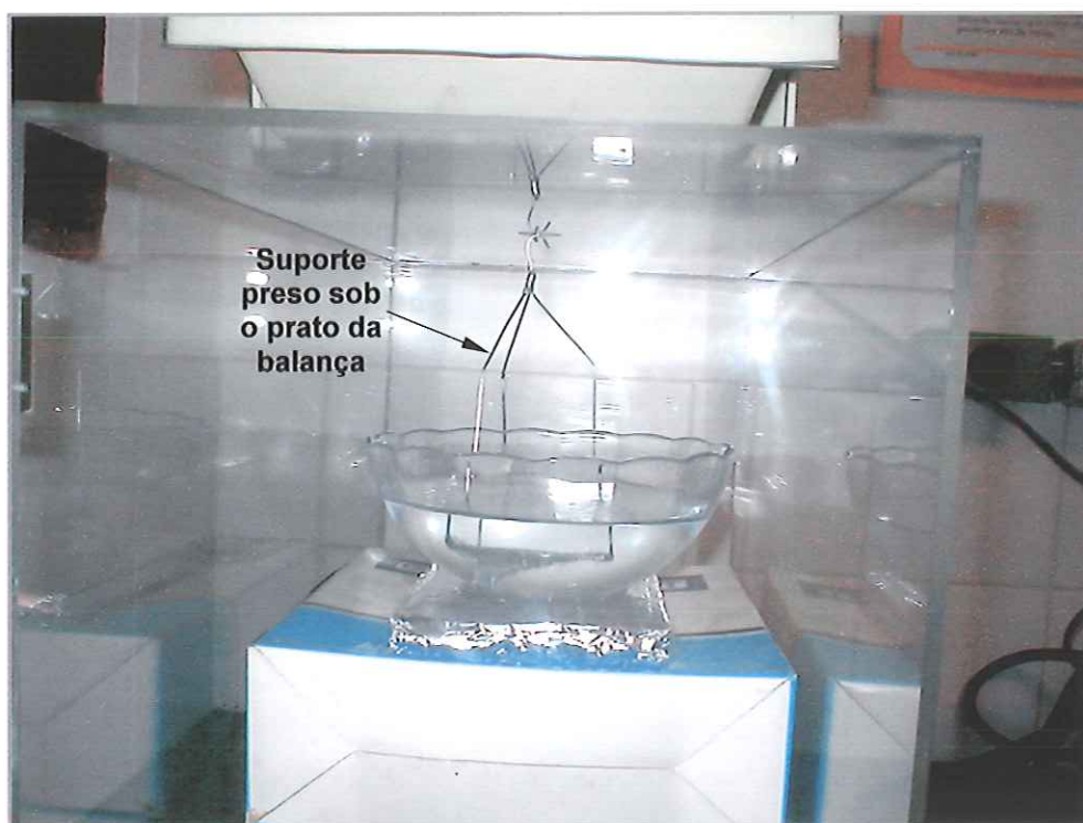
Figura 23: Suporte preso sob a balança e imerso em água destilada.
