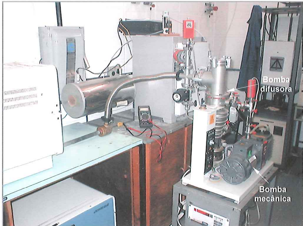
Figura 26: Bomba de vácuo utilizada.
