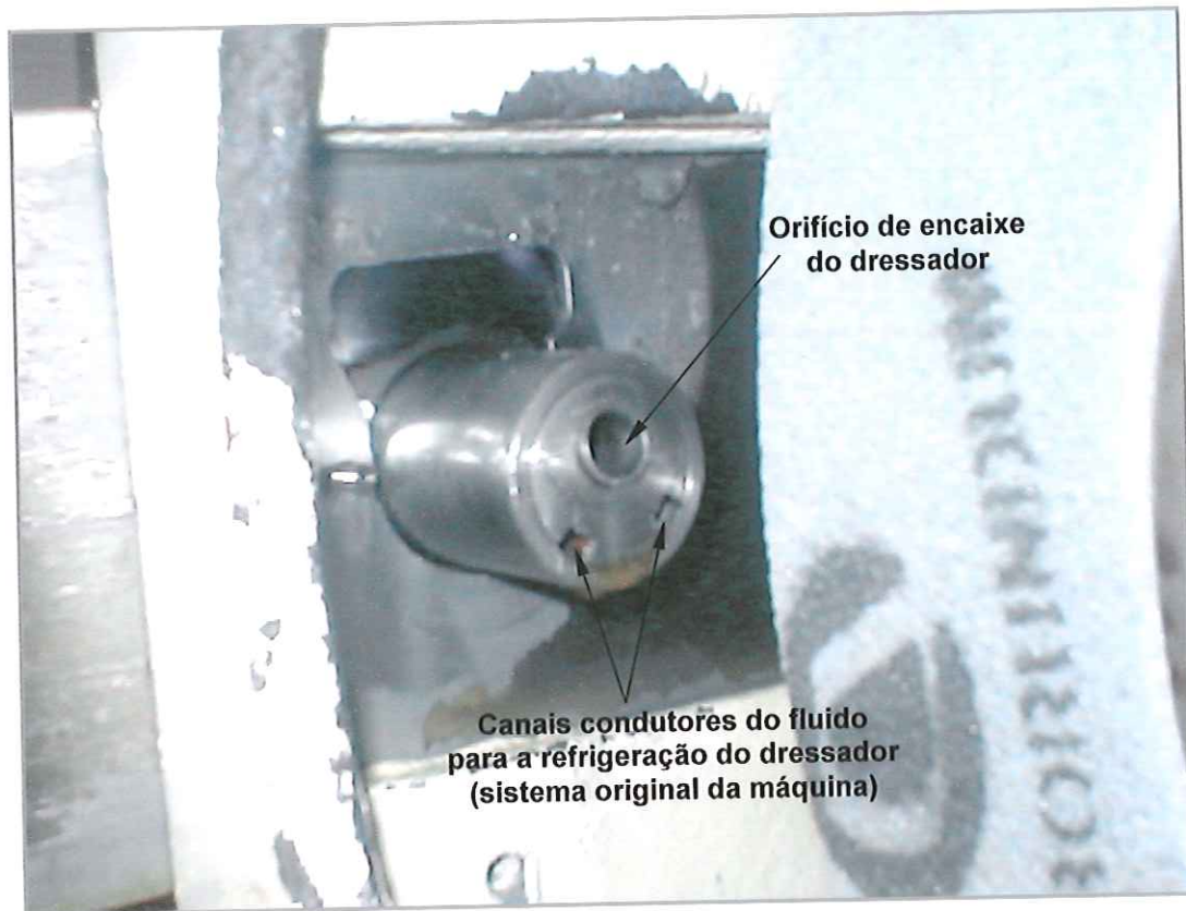
Figura 49: Sistema original de refrigeração do dressador na retificadora.
