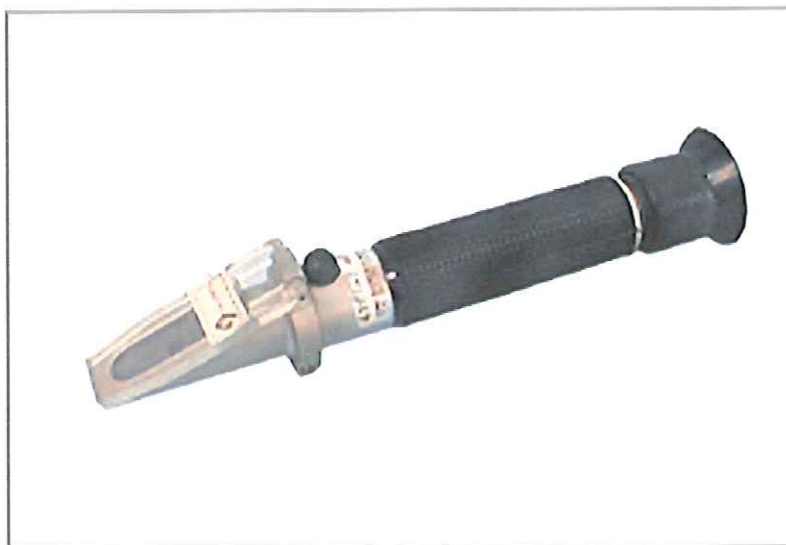
Figura 65: Refratômetro QUIMIS ® utilizado para medir a concentração do fluido refrigerante durante os ensaios ( www.quimis.com.br ).
