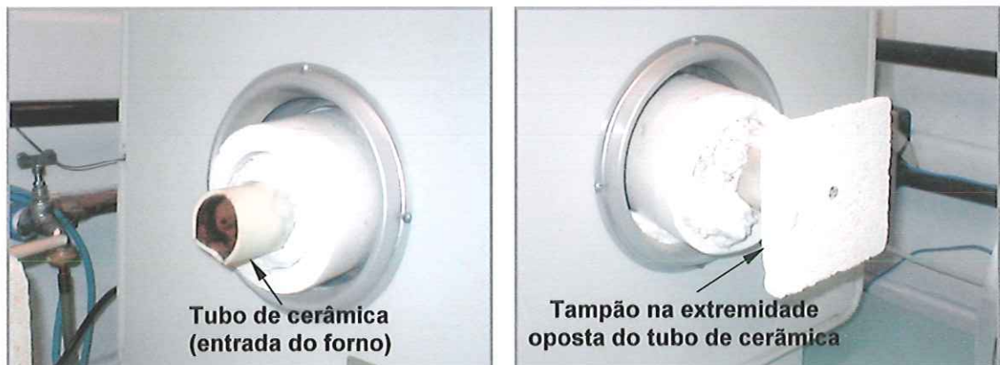
Figura 27: Entrada do forno e extremidade oposta do tubo de cerâmica com o tampão.
