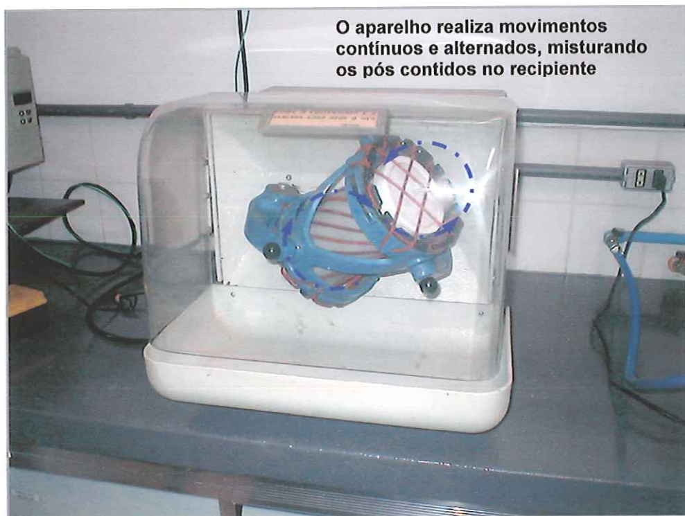
Figura 21 (b): Misturador Túrbula pronto para uso.
