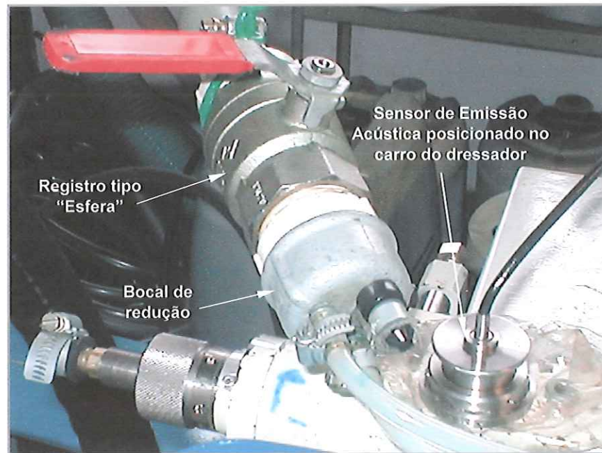
Figura 53: Detalhe do registro e do posicionamento do sensor de Emissão Acústica.
