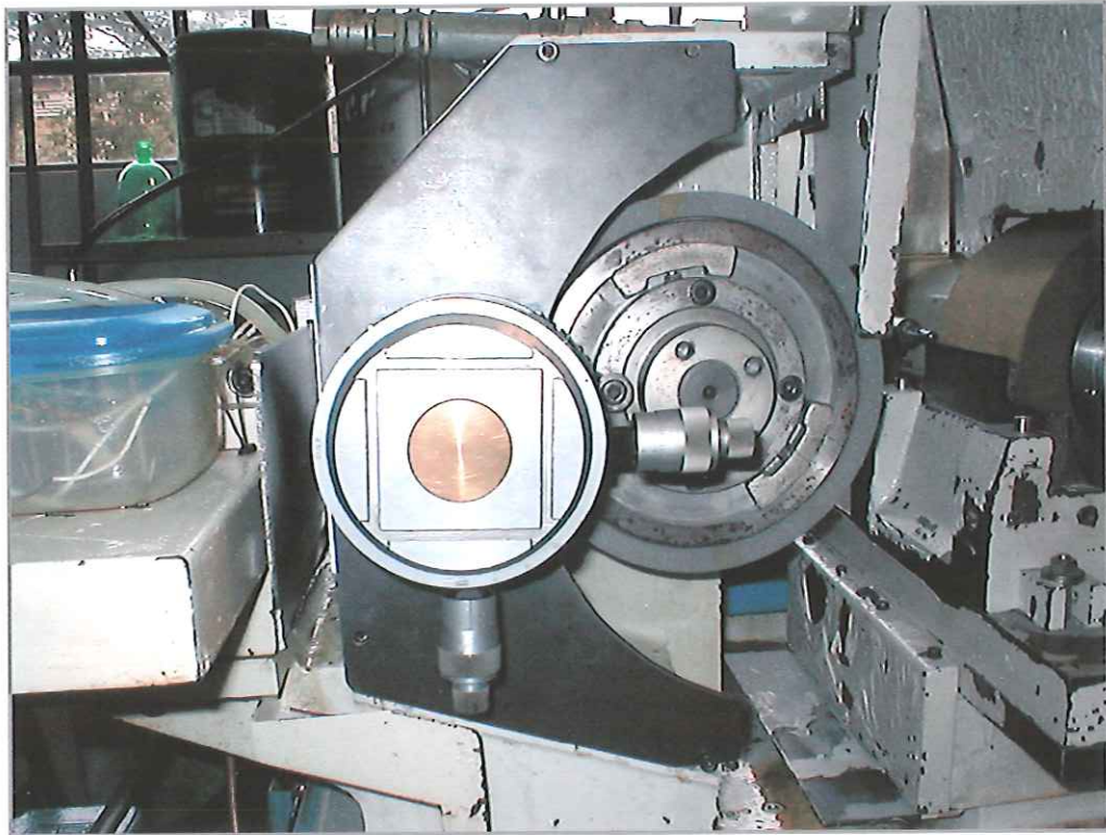
Figura 57: Posição na máquina do dispositivo de medição do desgaste dos diamantes.
