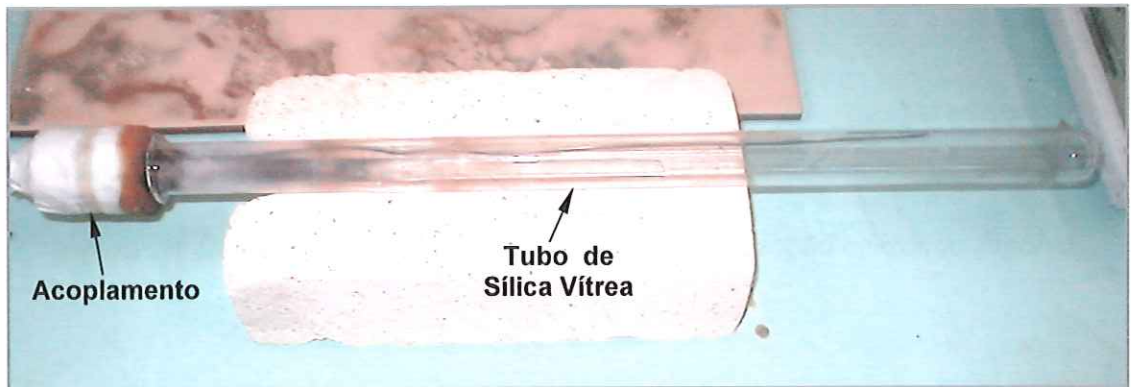
Figura 28 (b): Componentes para a sinterização utilizando Argônio.
