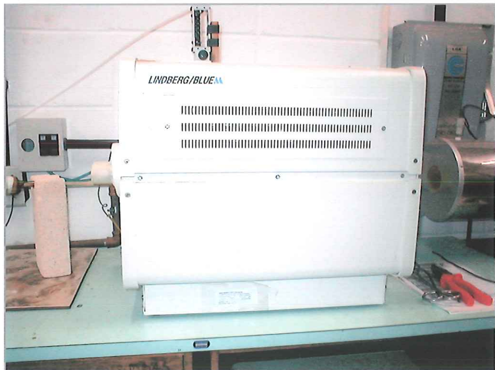
Figura 25: Forno tubular utilizado nas sinterizações.
