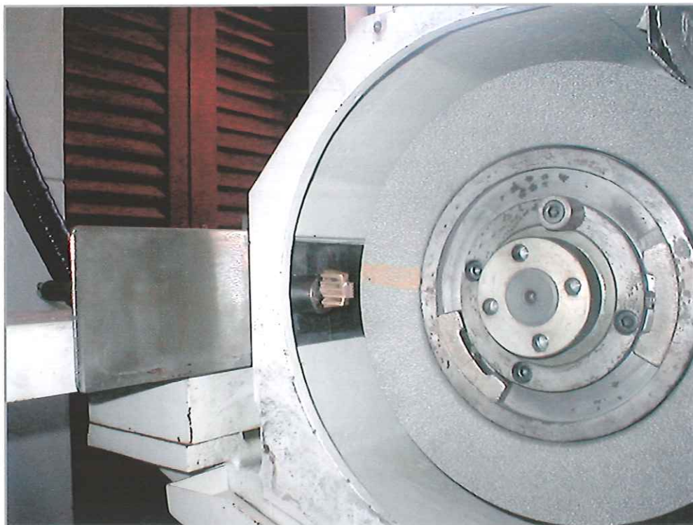
Figura 38: Posição do dressador aletado na retificadora.
