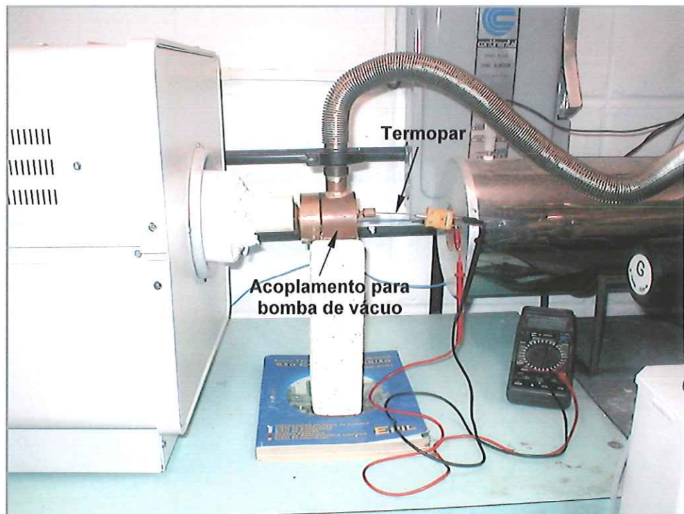
Figura 31: Disposição dos componentes na sinterização à vácuo.
