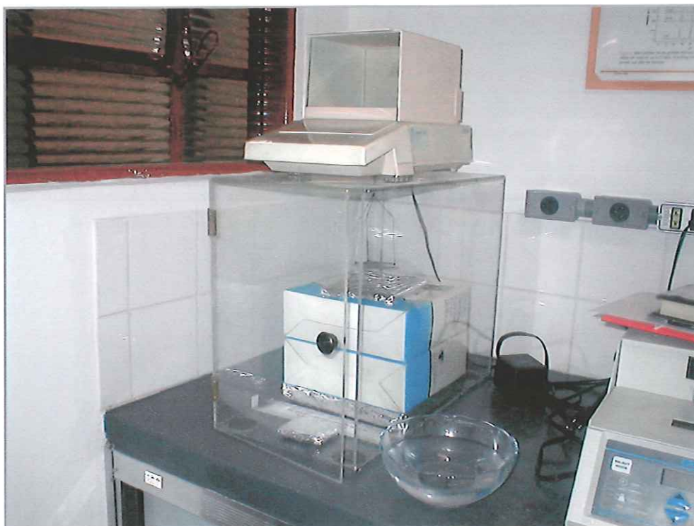
Figura 22: Visão geral da balança utilizada no cálculo da densidade aparente.
