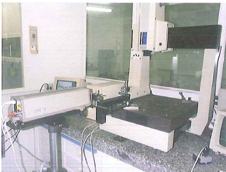
FIGURA 5.8 – MM3C e sistema interferométrico utilizado no levantamento dos erros cíclicos
