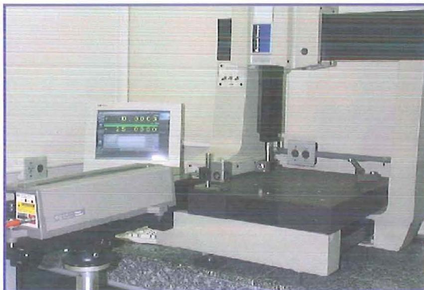
FIGURA A5.1 – Montagem experimental para a medição do erro de posição do eixo Y
