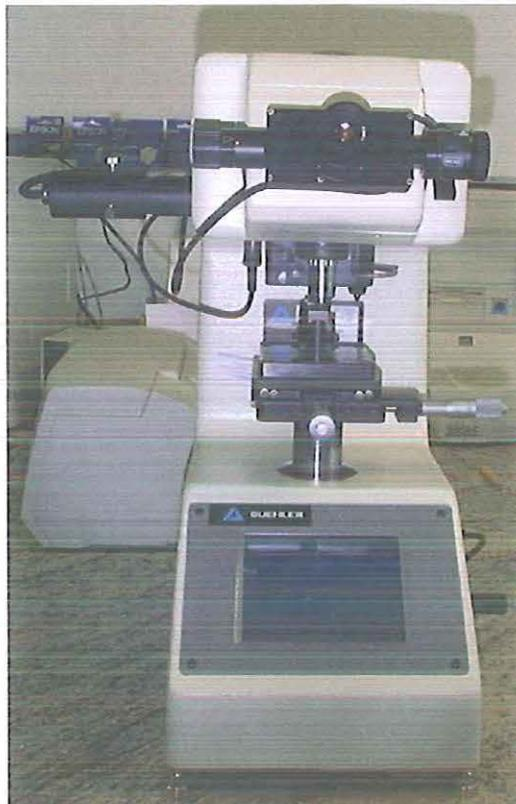
FIGURA 5.6 - Foto do microscópio utilizado para a medição do passo
