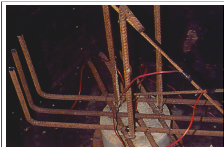
Figura 4.19. Instrumentação dos modelos Série A1
