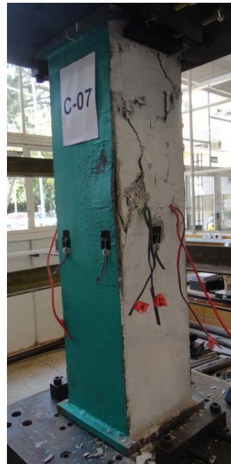
Figura 5.18 – Configuração deformada final do pilar C-07 a) Simulação numérica b) Ensaio experimental
