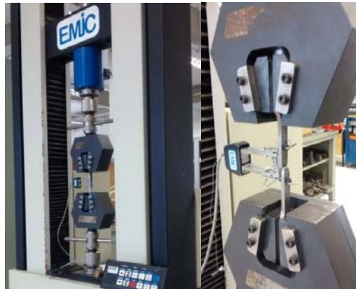
Figura 4.5 – Caracterização mecânica do aço dos perfis
