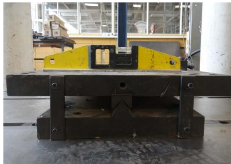
Figura 4.32 – a) Dispositivo de centralização; b) Nivelamento
