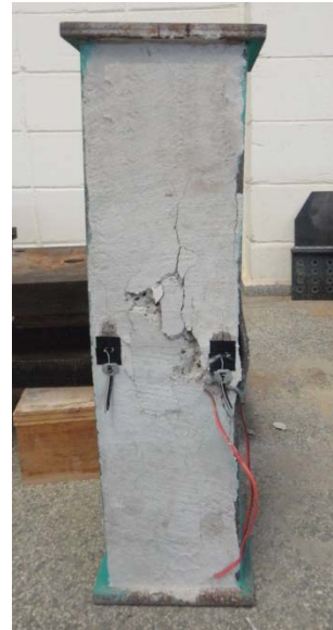
Figura 5.17 – Configuração deformada final do pilar C-04 a) Simulação numérica b) Ensaio experimental
