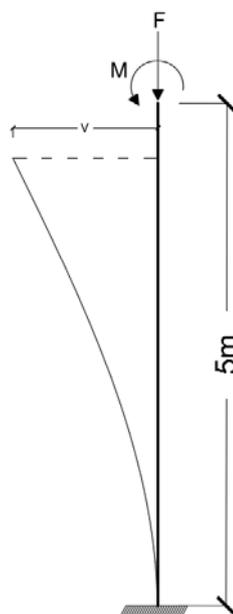
Figura 20 – Esquema para análise de flambagem de coluna.
