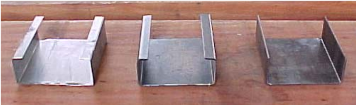
Figura 52 – Seguimentos de terças utilizadas nos ensaios.
