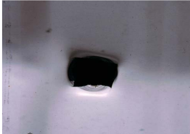
Figura 19 - Foto do detalhe do furo do puncionamento da chapa pelo PAA por tração – notar a retirada de material da telha, provavelmente depositada junto a cabeça do PAA ainda fixo a terça (ELLIFFRIT 2001).
