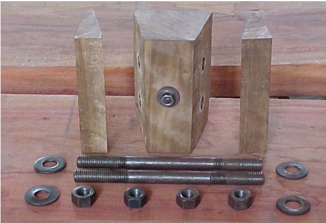
Figura 60 – Hastes transversais e calços de madeira do aparato de ensaio padrão AISI (1996).
