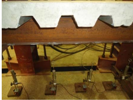
Figura 3-33 – Transdutores localizados abaixo da viga.
