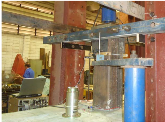
Figura 3-40 – Transdutor localizado próximo ao topo do pilar.
