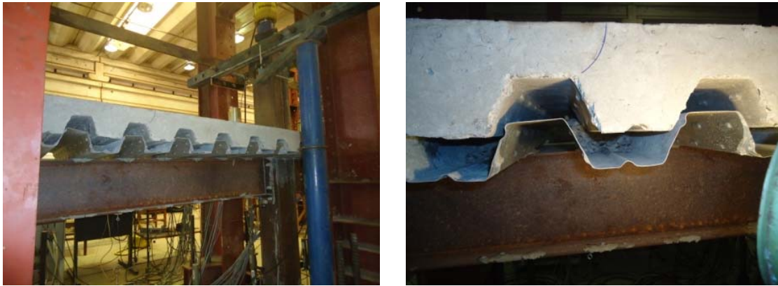
Figura 3-54 – Descolamento da viga e a laje do Modelo 1.
