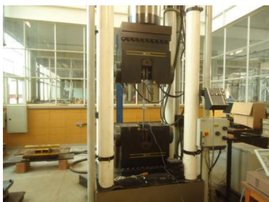
Figura 3-9 – Ensaio de tração de barra de aço realizado na Instron 8506.
