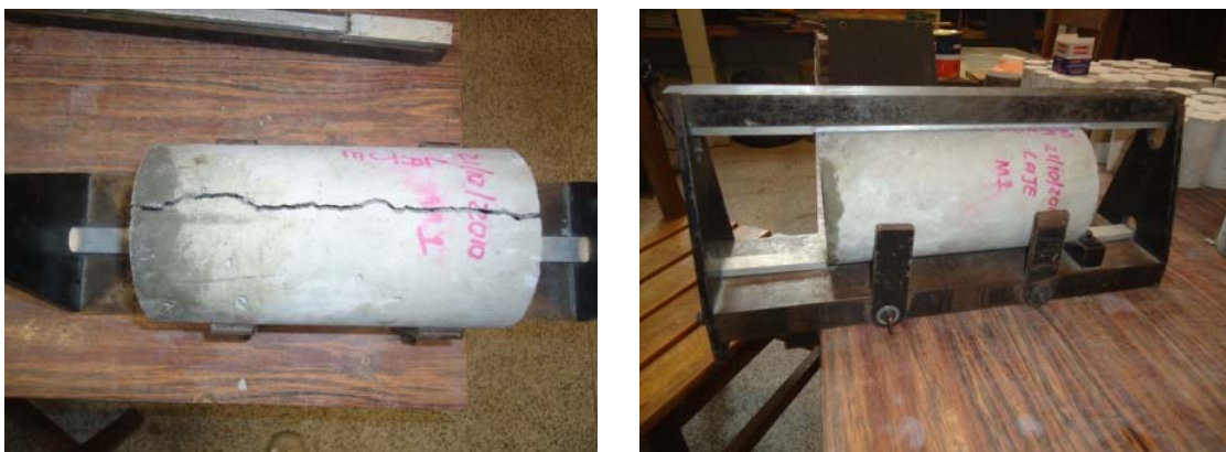
Figura 3-16 – Corpos-de-prova do ensaio de compressão diametral do concreto 3.
