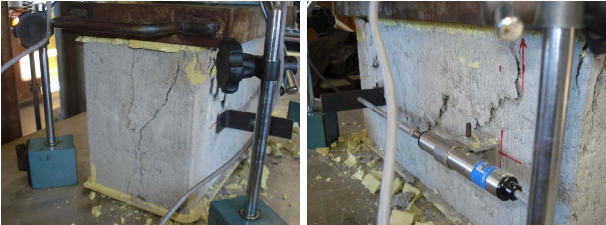
Figura 3.3 – Modo de ruptura dos blocos de concreto.
