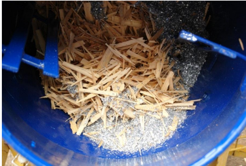
Figura 7: Partículas misturadas juntas na encoladeira.
