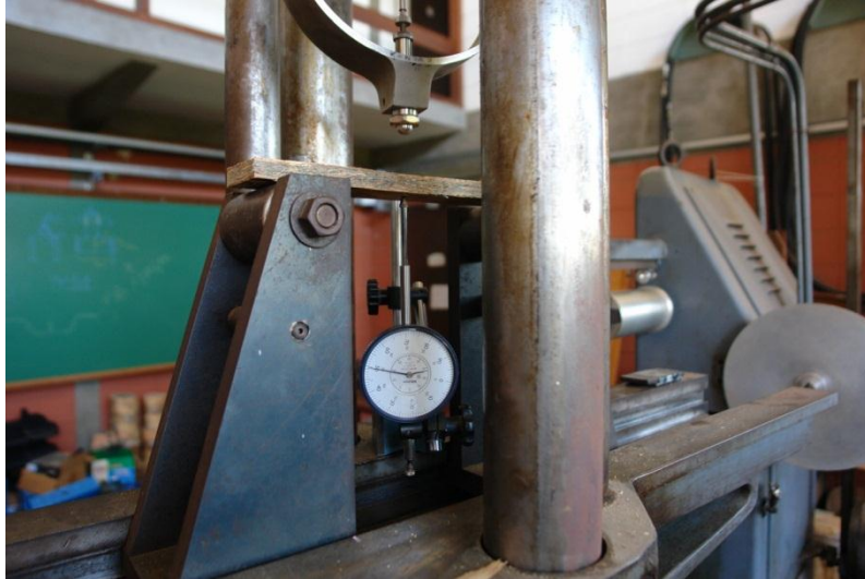
Figura 22: Dispositivo de ensaio para flexão estática.
