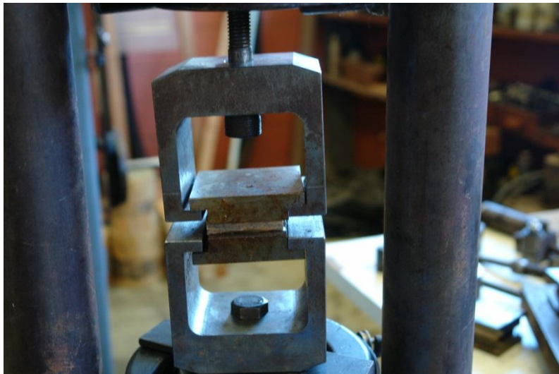
Figura 23: Dispositivo de ensaio para resistência à tração perpendicular.
