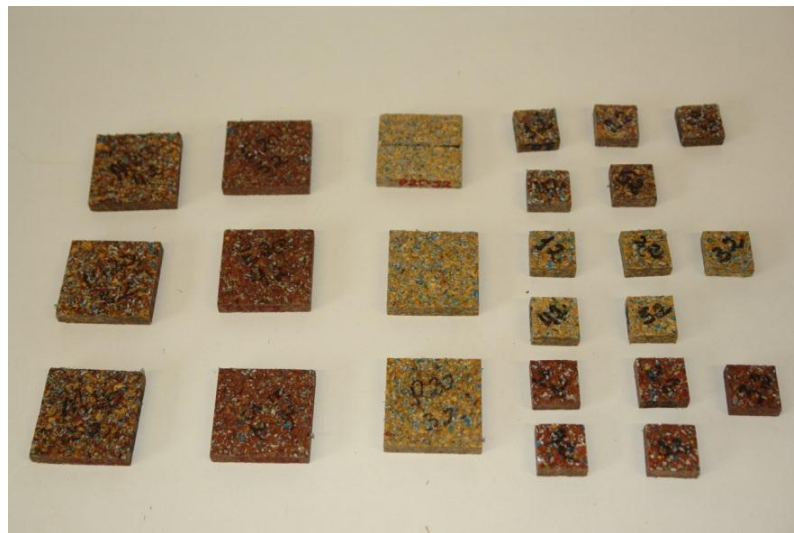
Figura 6: CPs confeccionados a partir dos painéis para os testes de tração perpendicular, inchamento em espessura, absorção de água e densidade aparente.
