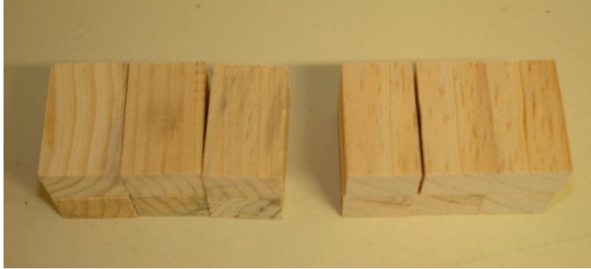
Figura 16: CPs utilizados na determinação da densidade aparente da madeira utilizada na produção dos painéis.
