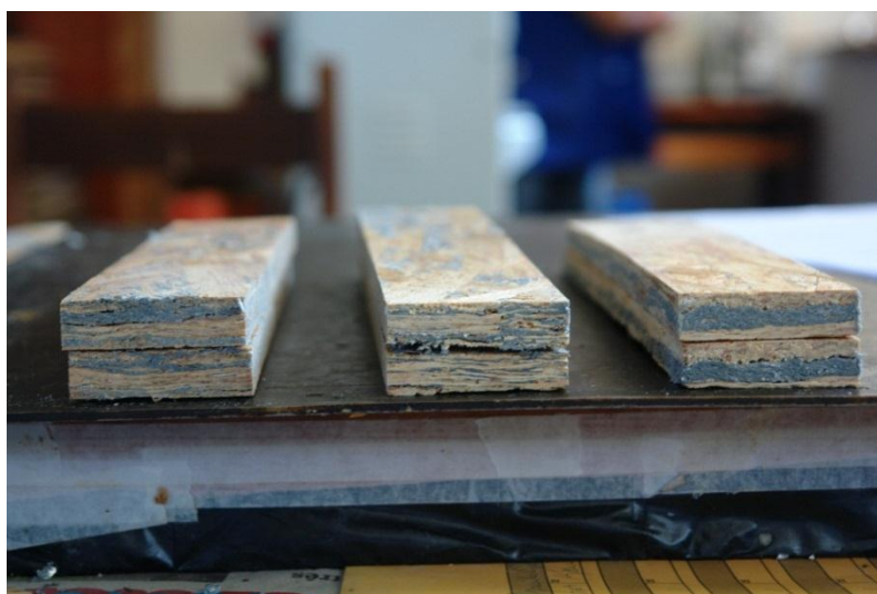
Figura 10: CPs para ensaios de flexão estática, painéis produzidos pelos métodos 1, 2 e 3, respectivamente.
