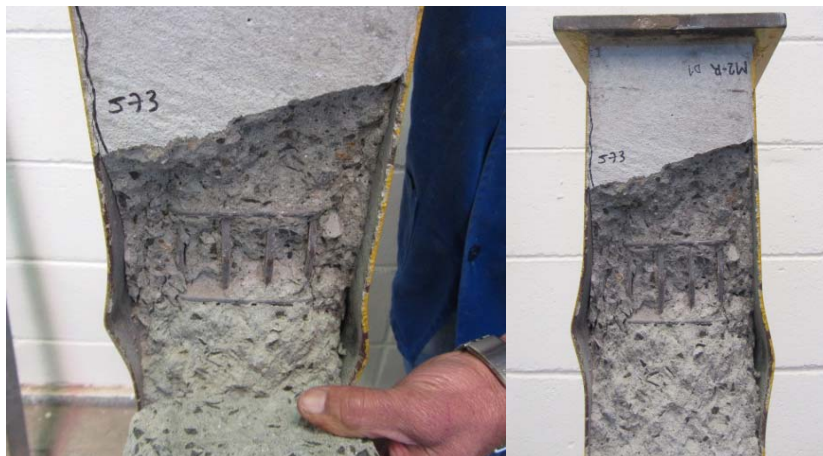
Figura 4.42 – Escoamento da tela de aço no modelo M2-R
