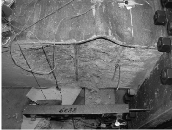
Figura 2.13 – Falha padrão de um dos modelos analisados (B4-WP40). (OH et. al., 2006)
