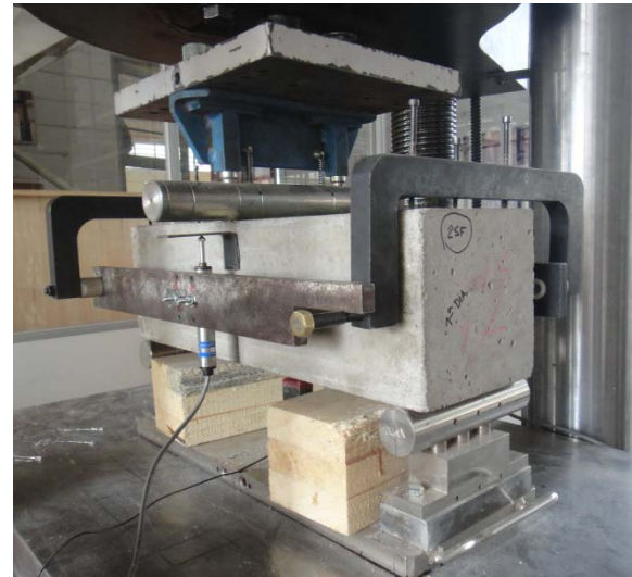
Figura 4.14 – Esquema de Ensaio de flexão sob três pontos de carga (Unidades em mm)
