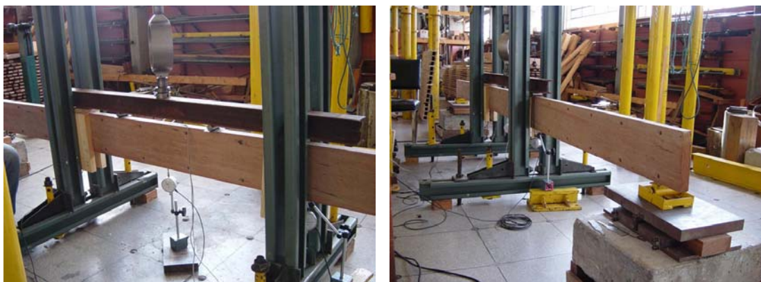
Figura 101 – Ensaio de flexão estática das nervuras
