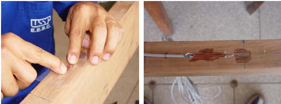
Figura 95 – Instalação de extensômetro elétricos
