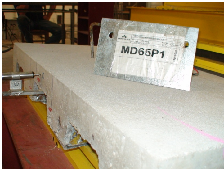
Figura 5.2 – Deslizamento relativo típico entre o concreto e a fôrma na extremidade.
