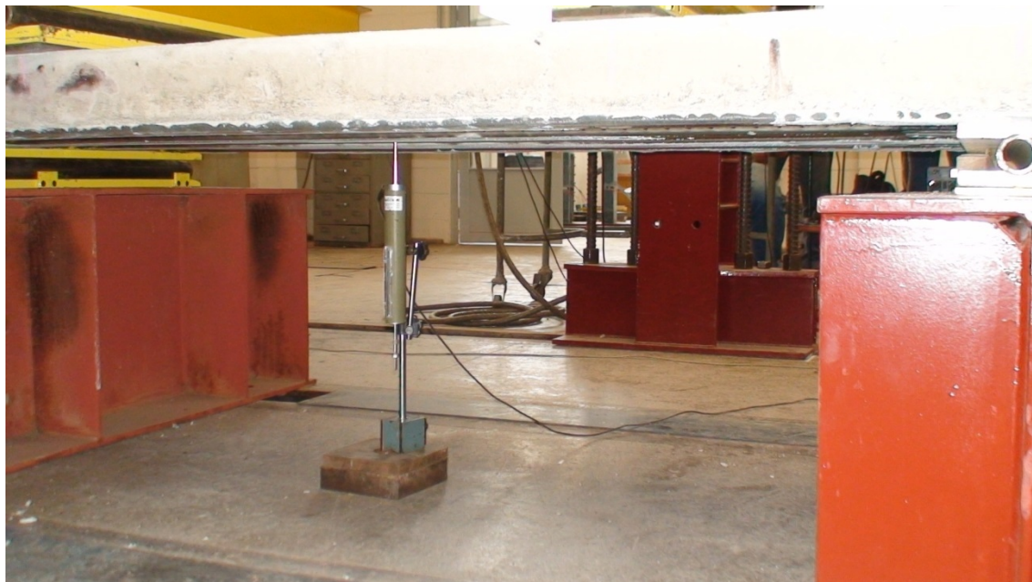
Figura A.8 – Transdutor para medição do deslocamento vertical a meio vão (flecha).
