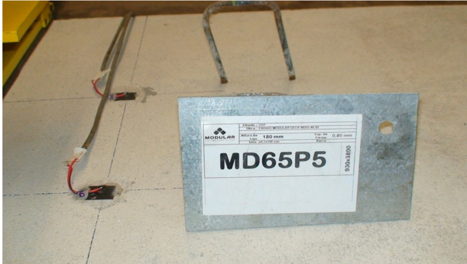
Figura 4.7 – Extensômetros elétricos na face superior da laje.
