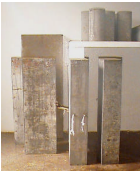
Figura 4.34. Pilares e corpos-de-prova sendo curados em câmara úmida.
