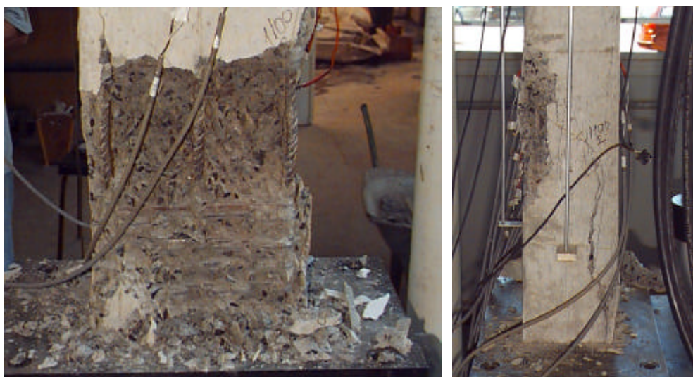
Figura 5.7. Pilar P2-12,5-150. a) Flambagem das barras longitudinais de uma face; e b) Esquema de fissuras característico de elementos submetidos à compressão simples.
