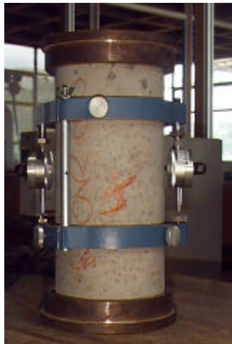
Figura 5.108. Corpo-de-prova instrumentado com dois transdutores de deslocamento.
