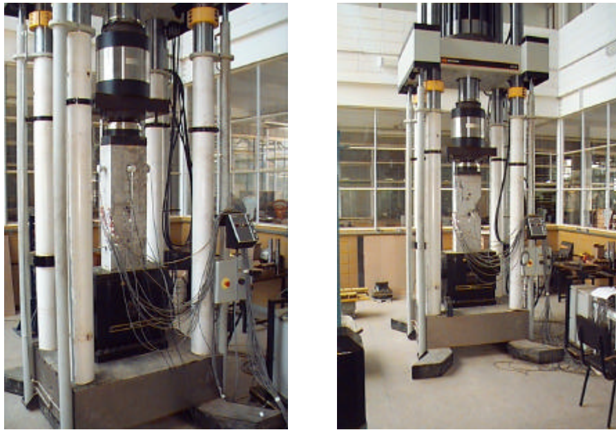
Figura 4.35. Pilares P2-10,0-120 e P3-12,5-75 sendo ensaiados na Instron.
