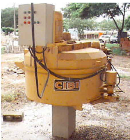
Figura 4.31. Betoneira utilizada no amassamento do concreto.
