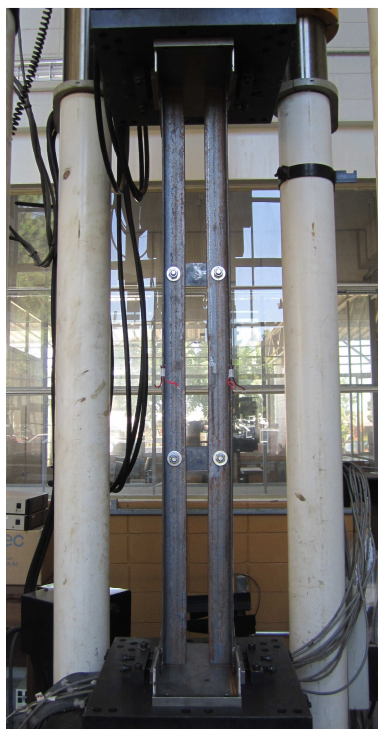
Figura 5.114 – Instabilidade por flexão em relação ao eixo de menor inércia do conjunto (F) ( L_c = 1200 mm – 2 chapas separadoras – compressão excêntrica)
