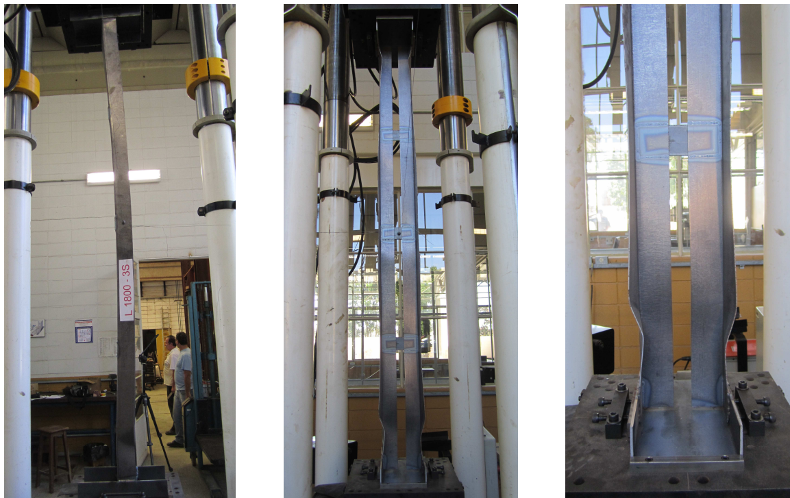
Figura 5.97 – Instabilidade por flexo-torção (FT)/flexão em relação ao eixo de menor inércia do conjunto (F) ( L_c = 1800 mm – 3 chapas separadoras soldadas – compressão excêntrica)
