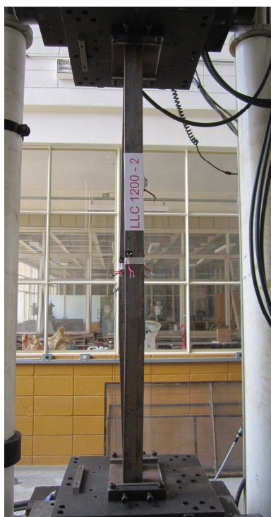
Figura 5.115 – Instabilidade por flexão em relação ao eixo de menor inércia do conjunto (F)/flexão em relação ao eixo paralelo à aba conectada ( F^* ) ( L_c = 1200 mm – 2 chapas separadoras – compressão centrada)
