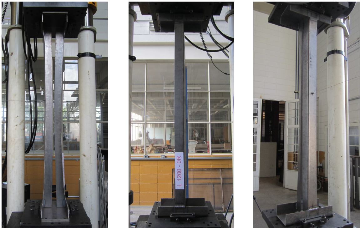
Figura 5.92 – Instabilidade por flexo-torção (FT)/flexão de cantoneira individual ( F^* ) ( L_c = 1200 mm – sem chapas separadoras – compressão excêntrica)
