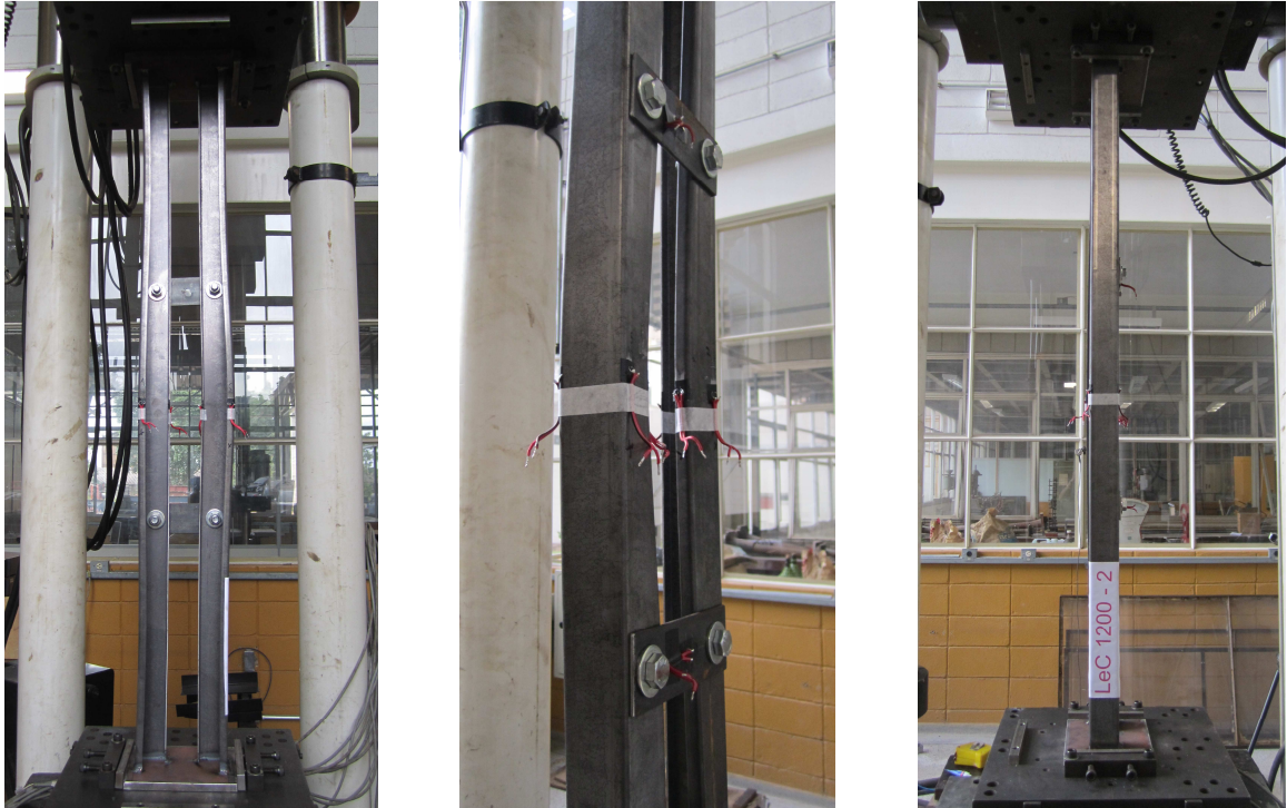
Figura 5.107 – Instabilidade por flexo-torção (FT) ( L_c = 1200 mm – 2 chapas separadoras parafusadas – compressão centrada)
