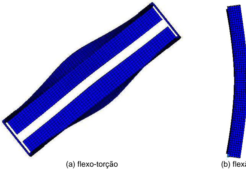
Figura 3.10 – Imperfeições adotadas para dupla cantoneira simples (compressão excêntrica)
