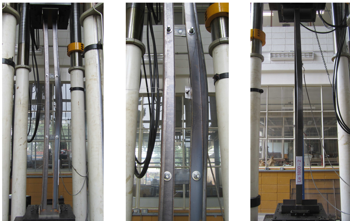
Figura 5.104 – Instabilidade por flexo-torção (FT)/flexão em relação ao eixo de menor inércia do conjunto (F)/flexão em relação ao eixo paralelo à aba conectada ( F^* ) ( L_c = 1800 mm – 2 chapas separadoras parafusadas – compressão excêntrica)
