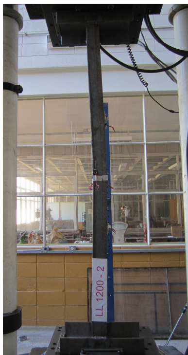
Figura 5.114 – Instabilidade por flexão em relação ao eixo de menor inércia do conjunto (F) ( L_c = 1200 mm – 2 chapas separadoras – compressão excêntrica)
