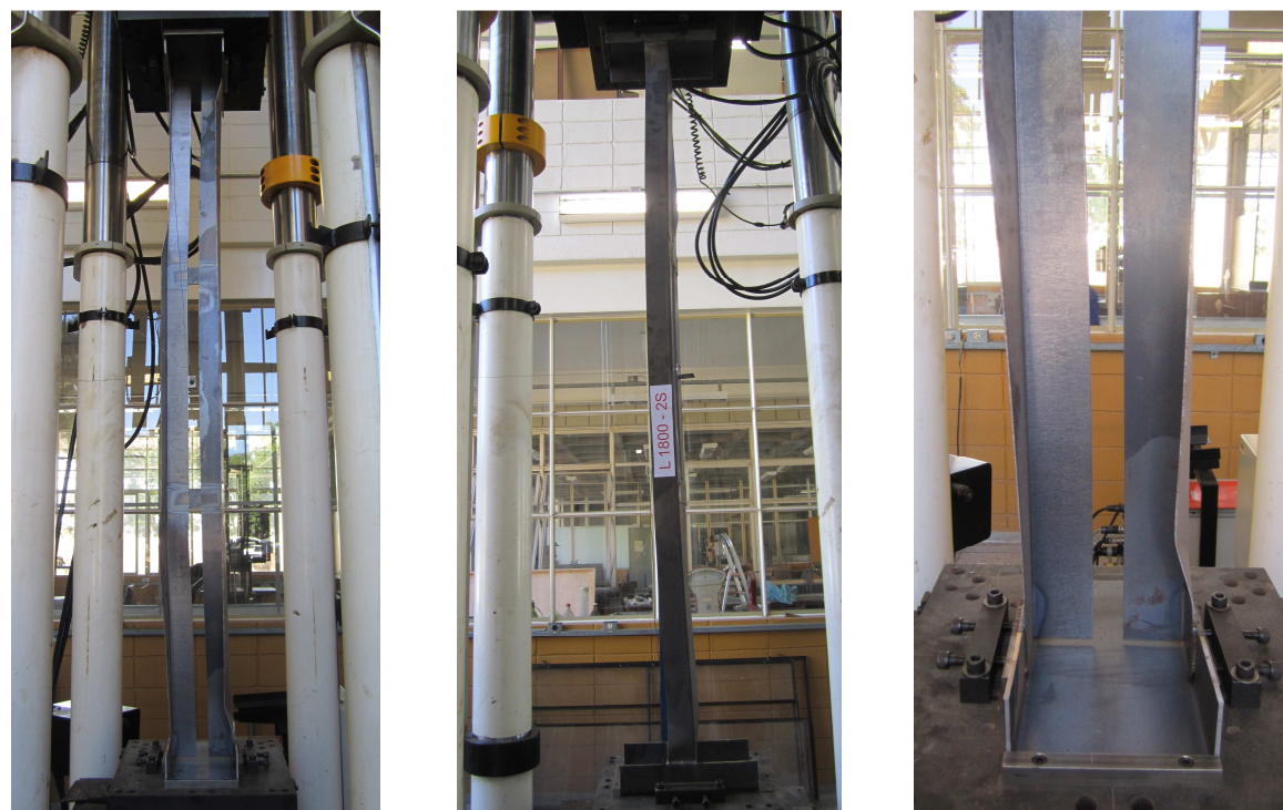
Figura 5.96 – Instabilidade por flexo-torção (FT)/flexão em relação ao eixo de menor inércia do conjunto (F)/flexão em relação ao eixo paralelo à aba conectada ( F^* ) ( L_c = 1800 mm – 2 chapas separadoras soldadas – compressão excêntrica)
