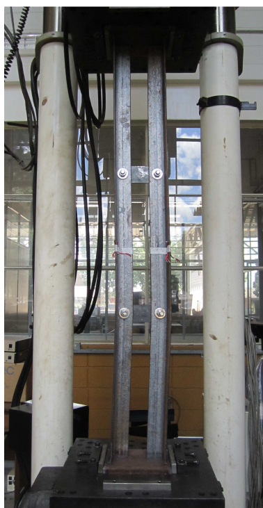
Figura 5.115 – Instabilidade por flexão em relação ao eixo de menor inércia do conjunto (F)/flexão em relação ao eixo paralelo à aba conectada ( F^* ) ( L_c = 1200 mm – 2 chapas separadoras – compressão centrada)
