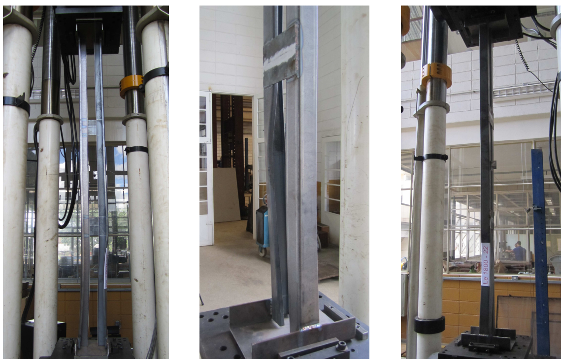
Figura 5.106 – Instabilidade por flexo-torção (FT)/flexão em relação ao eixo de menor inércia do conjunto (F)/flexão em relação ao eixo paralelo à aba conectada (F*) ( L_c = 1800 mm – 2 chapas separadoras soldadas (100mm) – compressão excêntrica)
