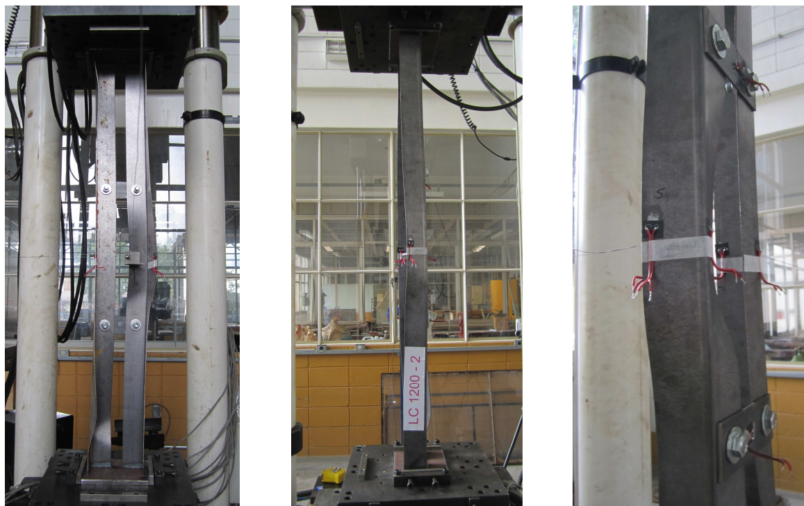
Figura 5.95 – Instabilidade por flexo-torção (FT) ( L_c = 1200 mm – 2 chapas separadoras parafusadas – compressão centrada)
